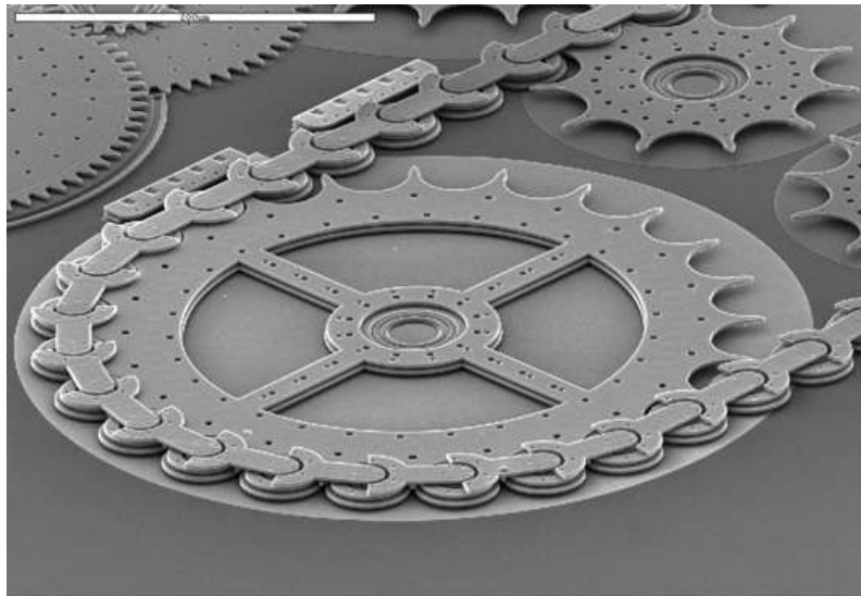
Figura 1. MEMS con función como Nano-cadena de transmisión de potencia mecánica. Formado por partes móviles de silicio en la nano escala y con espesores de 1 átomo (Gietzelt et al. 2004).
