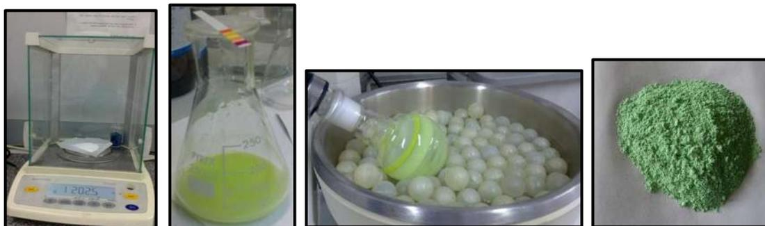
Figura 18. Impregnación de metales (NiMoW) por el método de humedad incipiente. (Gómez Orozco, 2014)
