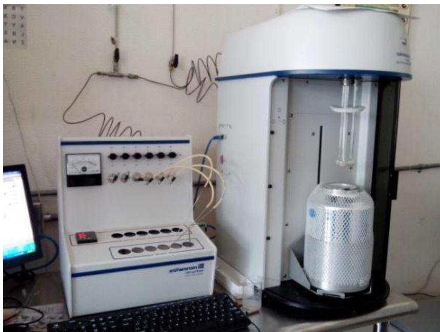
Figura 15. Equipo de fisisorción de nitrógeno
