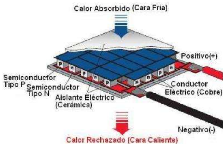
Figura 23. Estructura interna de una celda Peltier.
