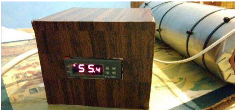
IMG. 26: Secador de barro realizando pruebas con el regulador controlador de temperatura Fuente: Elaboración propia.
