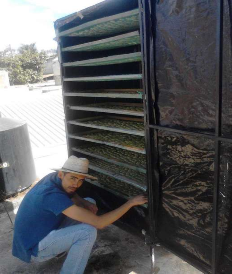
IMG. 24: Estructura para deshidratador solar fabricado en Uruapan ya forrado con plástico negro para Artocarpus Heterophyllus y otras frutas de temporada. Introduciendo frutas para probar como funciona.
