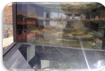
IMG. 28: Deshidratador solar de vidrio con fruta dentro deshidratándose. Fuente: Elaboración propia.
