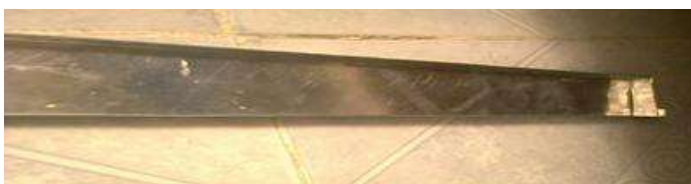
IMG. 14: Charola de lámina de acero para mejor secado de la Artocarpus Heterophyllus. Fuente: Elaboración propia.
