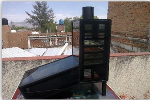
IMG. 29: Deshidratador solar de vidrio con fruta dentro deshidratándose Morelia. Fuente: Elaboración propia.
