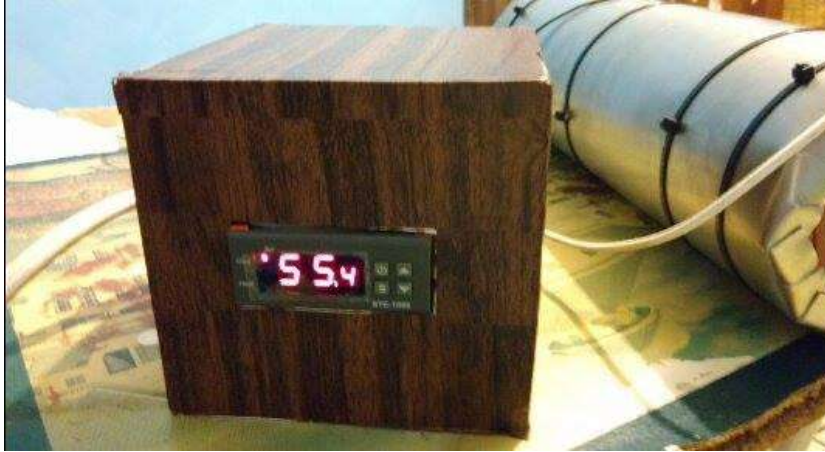
IMG. 15: Caja de control instalada con el controlador y sensor de temperatura conectado al secador de barro para Artocarpus Heterophyllus .
