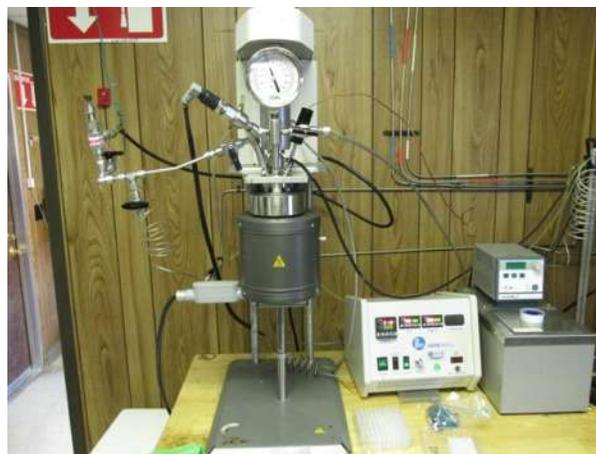
Figura 17. Reactor tipo Batch
