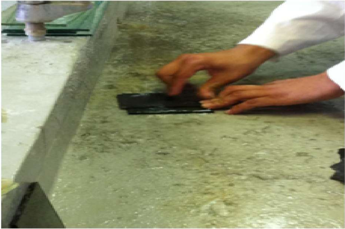
Figura 3.2 Desbaste de probetas.
