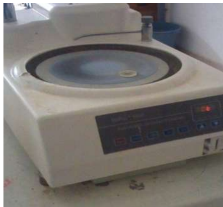
Figura 3.3 Pulidora utilizada para acabado espejo
