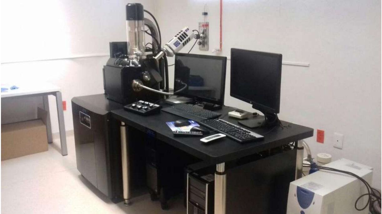
Figura 3.6 Fotografía del microscopio electrónico de barrido utilizado
