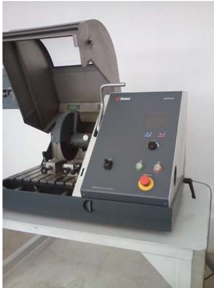
Figura 3.1 Fotografía de la cortadora utilizada.
