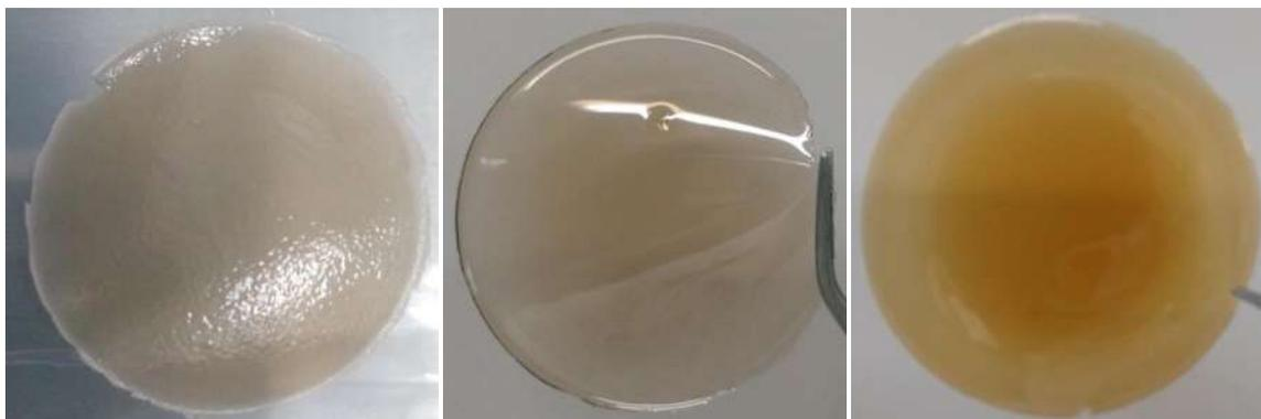
**Figura 32.** Membrana **DIC/HFDA**, **DIC/DABS/HFDA**, **DIC/DABS**, de izquierda a derecha, respectivamente.
