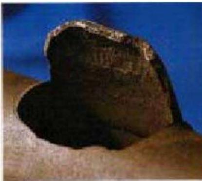
fig. 13 Rotura inducida por el hidrógeno.
