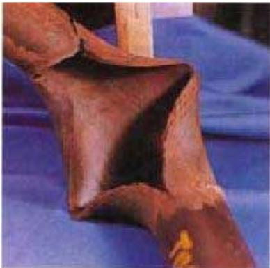
fig. 7 Rotura por flujo plástico
