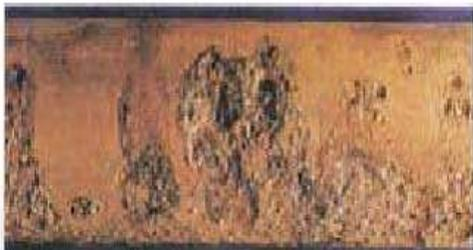
fig. 10 Corrosión provocada por exceso de oxígeno en la caldera
