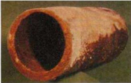
fig. 11 Corrosión por ceniza de combustible
