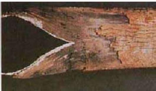
Figura 6. Falla de tubo de caldera por oxidación térmica
