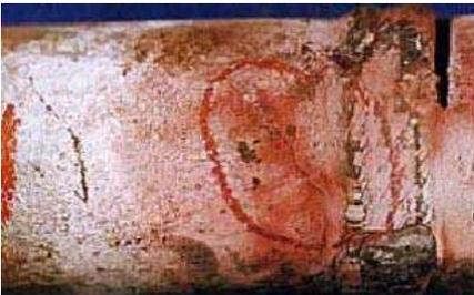
Fig 12 Tubería afectada por corrosión bajo esfuerzos
