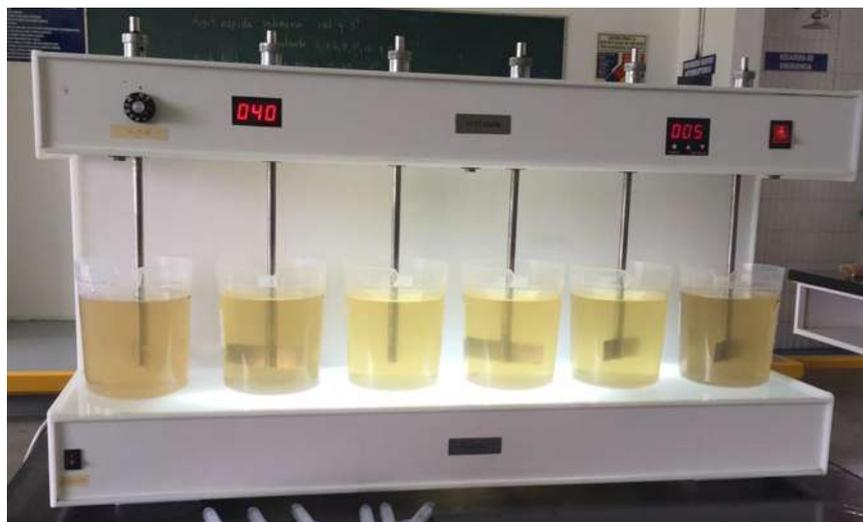
Figura VIII.8 Equipo para prueba de jarras con policloruro de aluminio
