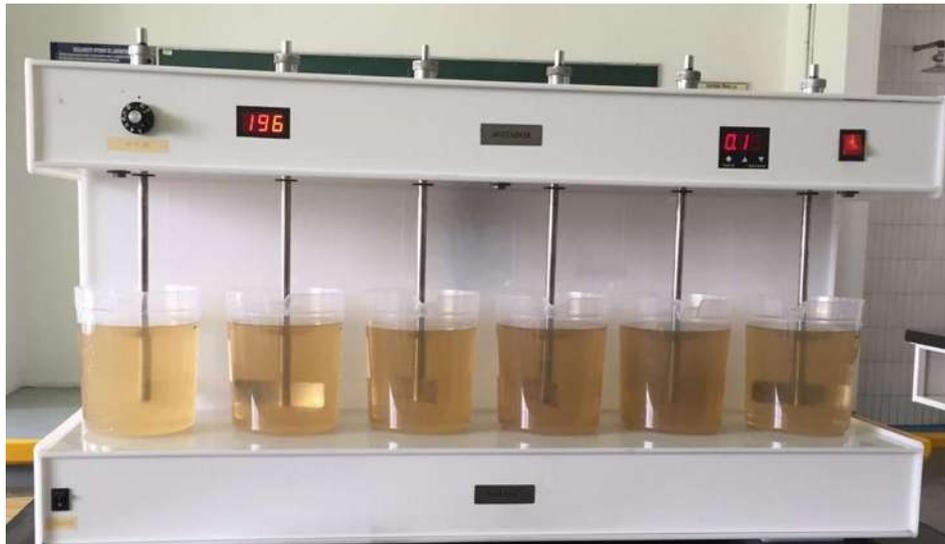
Figura VIII.6 Equipo para prueba de jarras con complejo polímero – sulfato Al.
