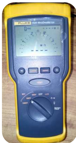
Fig. 27 Megohmetro Fluke 1520, medidor de Resistividad Eléctrica.
