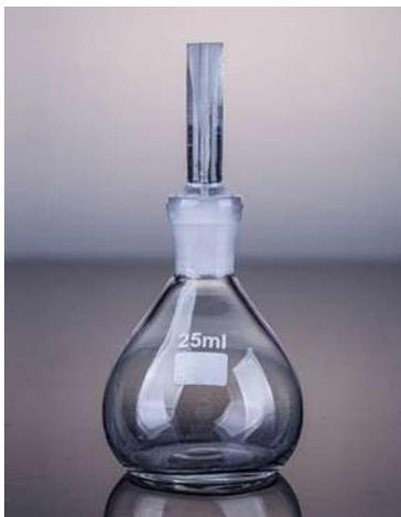
**Figura 8.** Picnómetro para líquidos de baja viscosidad.
