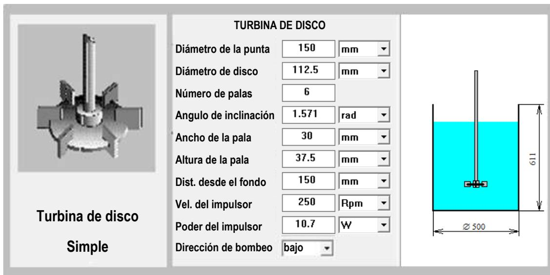
Figura 21. Impulsor y especificaciones de diseño.
