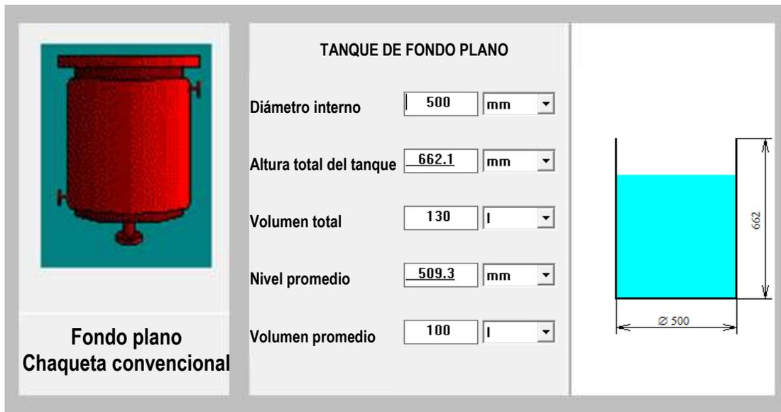
Figura 22. Tanque y especificaciones de diseño.
