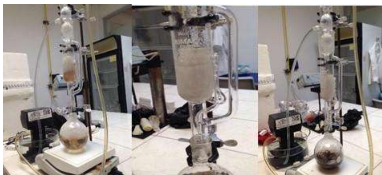
Fig. 12: Proceso de tratamiento térmico de las fibras en un equipo Soxhlet.
