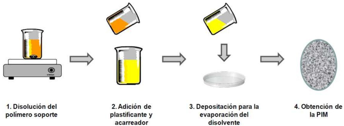
Figura 16. Esquema general para la elaboración de la membrana polimérica de inclusión (PIM)
