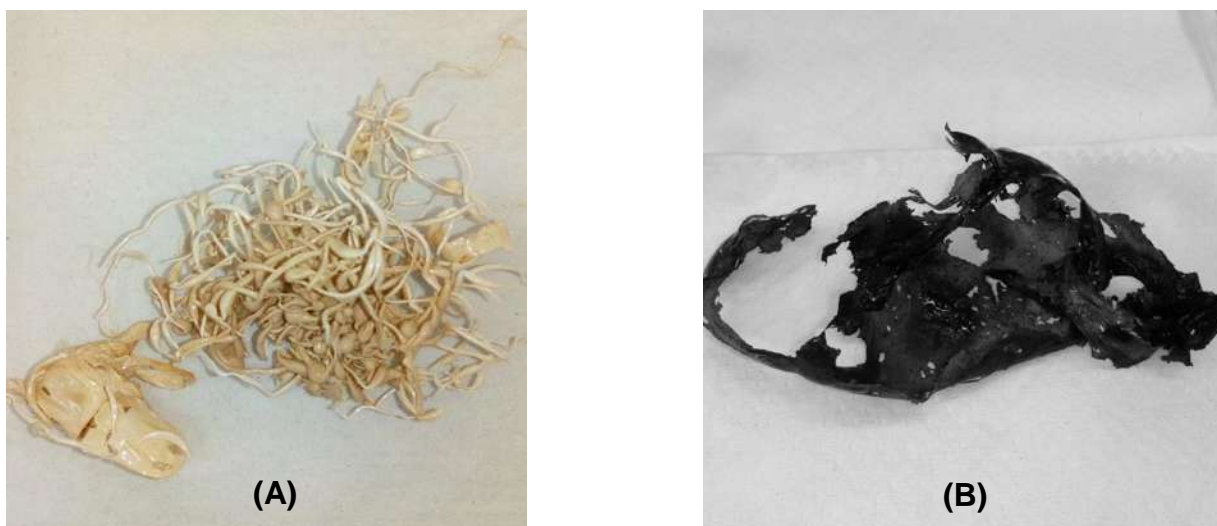
Figura 14. Imagen fotográfica de ( A ) polímero hidrogenado 3a y ( B ) polímero sulfonado 4a .
