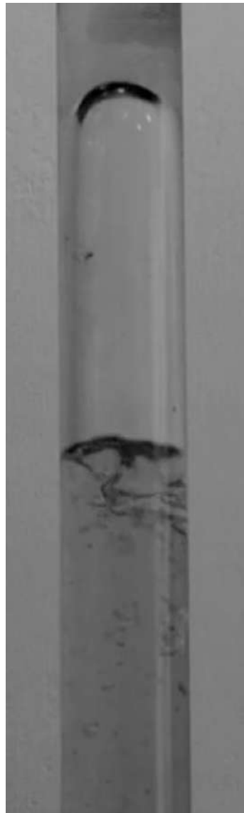
Figura 1. Burbuja de Taylor fluyendo a través de una tubería vertical (Michaelides 2006).
