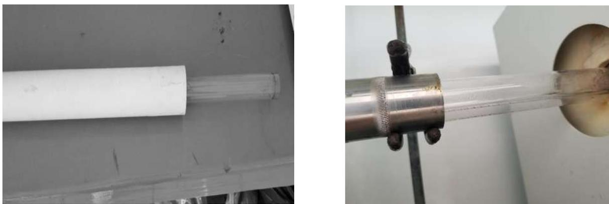
*Fig. 38. Tubo de cuarzo del horno tubular*
