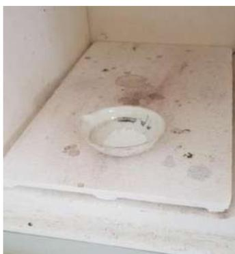
5. Secado a 110°C por 24 h y calcinación a 500°C por 6 h
