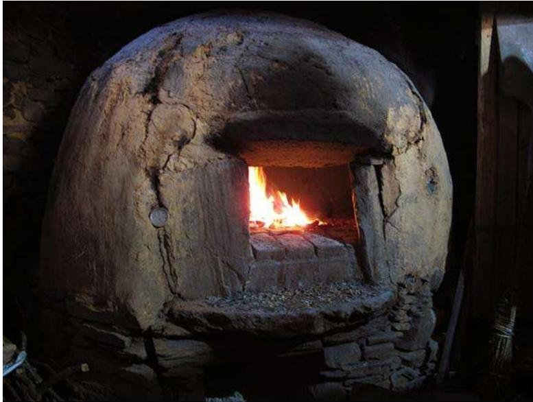
*Fig. 2. Horno a base de carbón para fundir metales*
