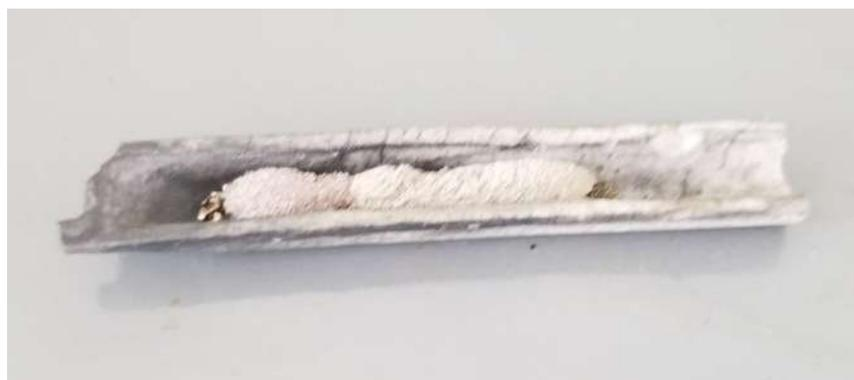
*Fig. 39. Canaleta de calcinación de alúmina*
