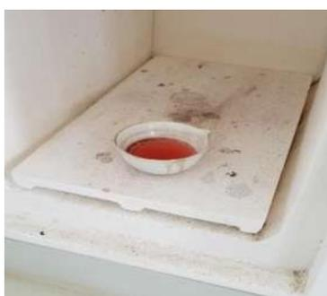
5. Secado a 110°C por 14 h y calcinado a 500°C por 4 h
