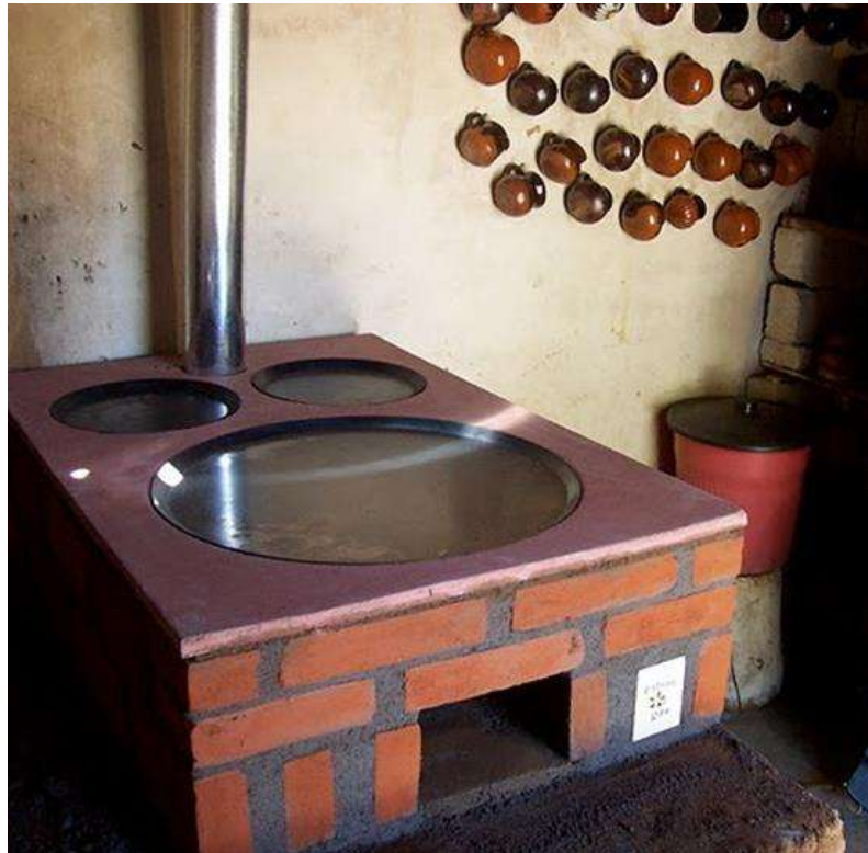
Figura 2. Estufa eficiente "Patsari"
