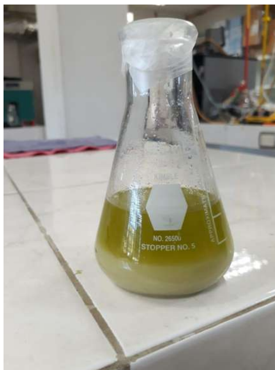
Ilustración 13. Estancamiento del concentrado con papel filtro y fibra precipitada en los filtrados
