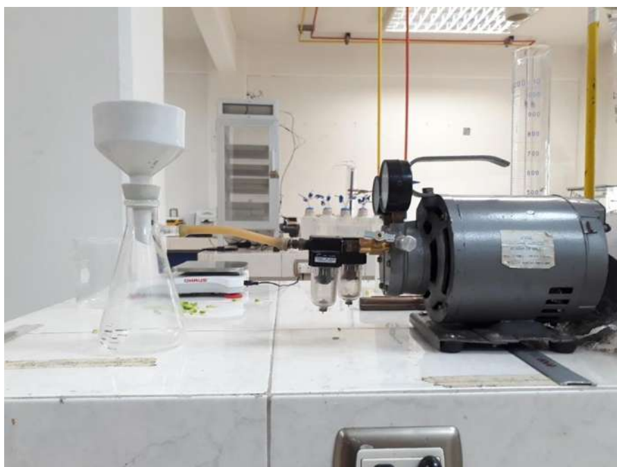
Ilustración 5. Sistema a nivel laboratorio para el proceso de filtración a vacío
