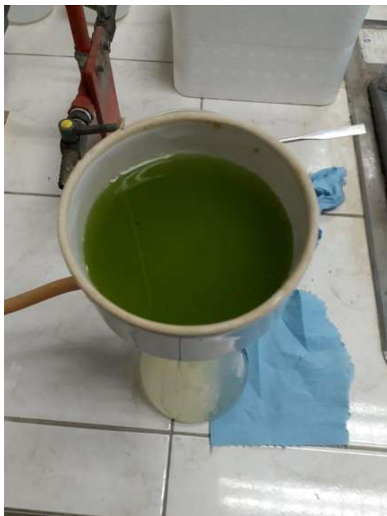
Ilustración 13. Estancamiento del concentrado con papel filtro y fibra precipitada en los filtrados
