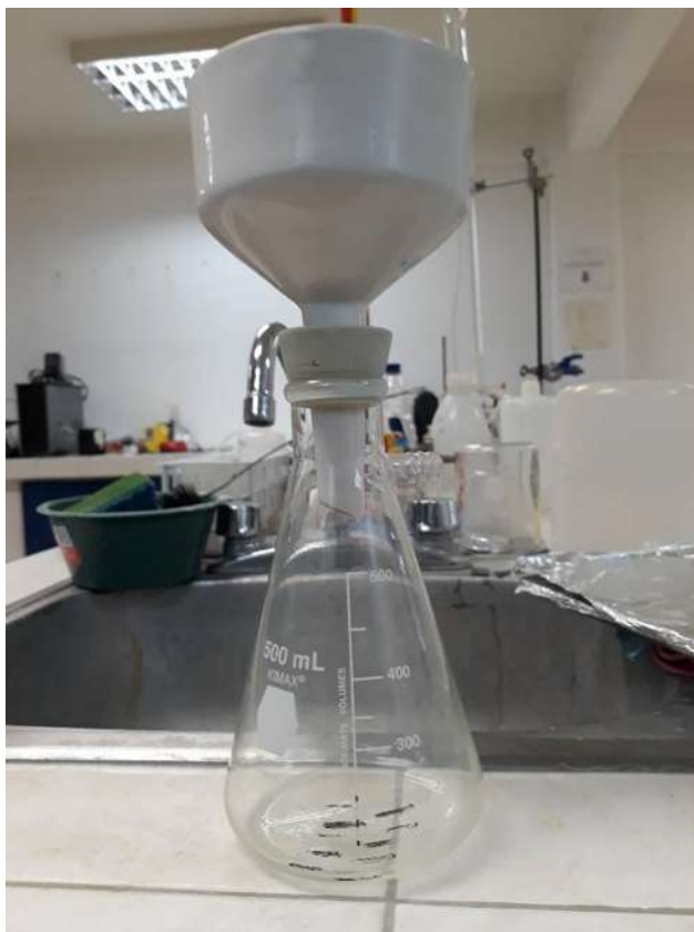
Ilustración 6. Conexión del embudo y del matraz a través de un tapón de caucho
