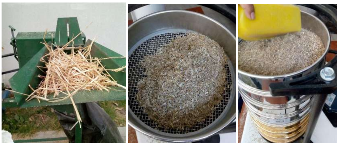
Figura 19. Molido y tamizado de los materiales a) Molido b) Malla de tamizado c) Tamizador
