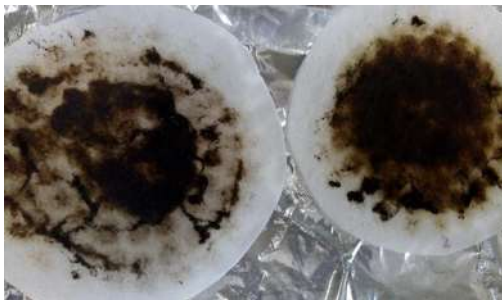
Figura 29. Evidencia de lignina insoluble de los hidrolizados
