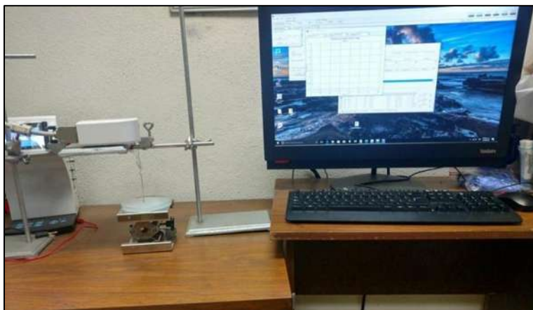
Figura 2.8 Arreglo experimental usando el tensiómetro de Du Noüy Padday.
