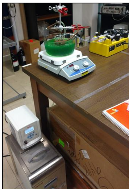
Figura 2.3 Arreglo experimental para la síntesis de nanopartículas de ZnO.
