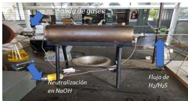
Figura 13. Activación ex situ de los catalizadores en horno tubular.
