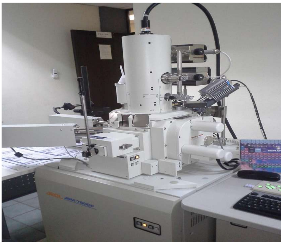
Figura 3.8 Microscopio electrónico de barrido MEB modelo JSM-7600 JEOL Noran Instruments
