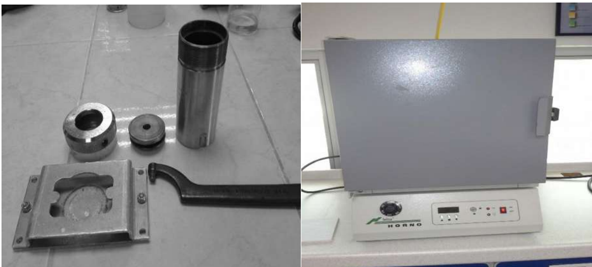
Figura 3.2 Equipo para síntesis hidrotérmico y horno marca Felisa
