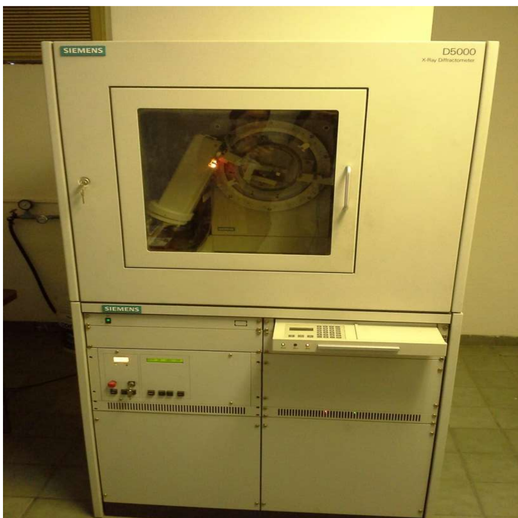
Figura 3.9 difracción de rayos X XRD, SIEMENS D5000 X-Ray diffractometer.
