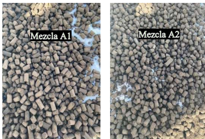
Figura 25 Pellets obtenidos para mezclas de aserrín de pino y carbón vegetal de aserrín de pino
