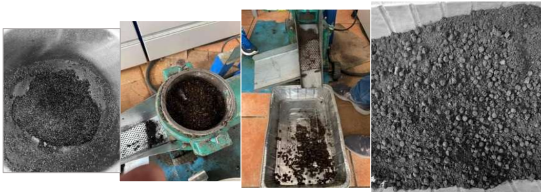
Figura 16. Proceso de pelletizado en la primera ronda de la mezcla B1.
