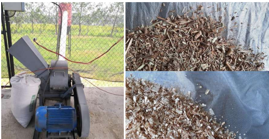
Figura 8. Trituradora de ramas y hojas (Izquierda). En la derecha, tamiz de rastrojo de frutillas (Arriba). Tamiz de aserrín de pino (abajo).
