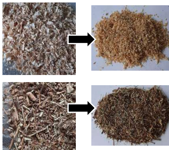
Figura 17 Aserrín de pino (arriba) y rastrojo de frutillas (abajo), antes y después de tamizar.
