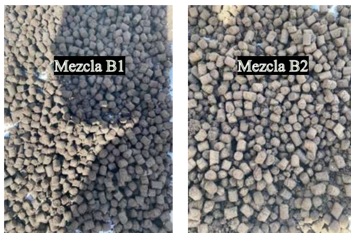
Figura 26. Pellets obtenidos para rastrojo de frutillas y carbón vegetal de rastrojo de frutillas.
