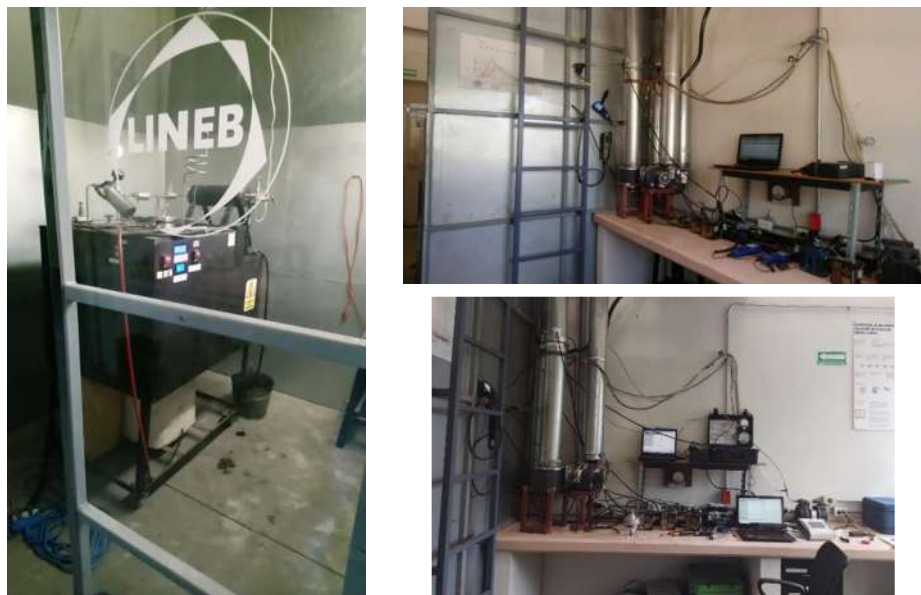
Figura 12. Instalación del GASIFICADOR EMII-01 y equipos de muestreo.
