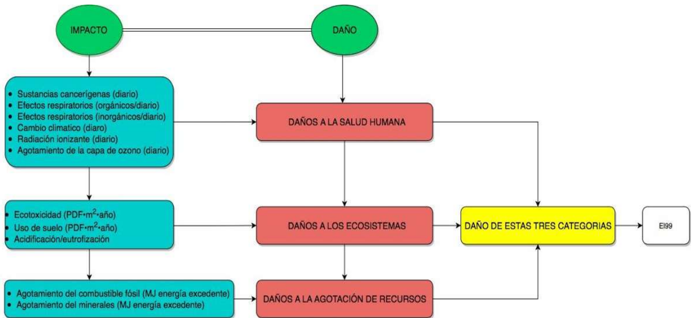
Figura 7 : Categorías de impacto y daño para calcular el valor del Eco-indicador 99.
