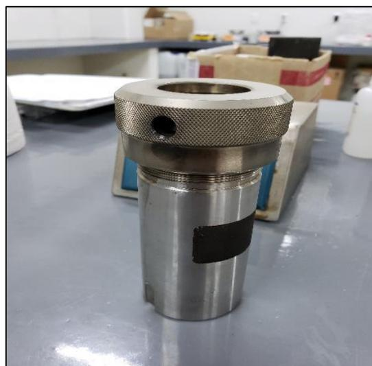
Figura 6. Autoclave para síntesis hidrotérmal.
