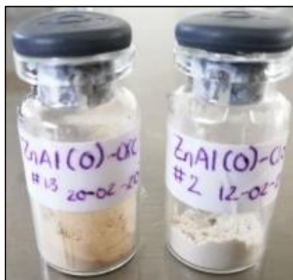
Ilustración 12.- HDL después del proceso en la mufla
