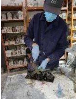
Ilustración 52. Primera capa de mortero de 25 mm aprox. Fuente: Propia.
