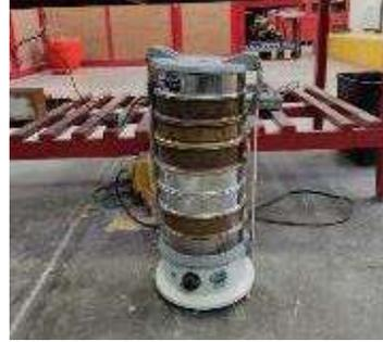
Ilustración 16. Mallas ordenadas y acomodadas para la prueba. Fuente: Propia.
