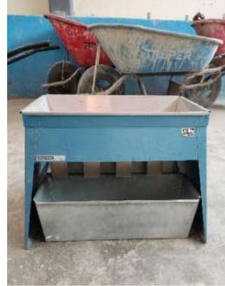
*Ilustración 10. Colocación de charolas debajo del cuarteador en ambos lados. Fuente: Propia.*
