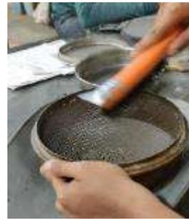
Ilustración 18. Se retiran los agregados atorados en la malla. Fuente: Propia.
