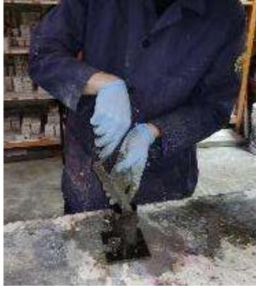
*Ilustración 64. Llenado de primera capa de mortero. Fuente: Propia.*
