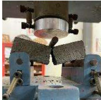
Ilustración 76. Momento de falla de espécimen prismático. Fuente: Propia.
