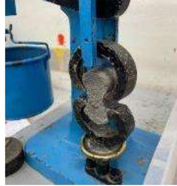
*Ilustración 78. Briqueta colocada en mordaza antes de su ensayo a tensión. Fuente: Foto propia.*
