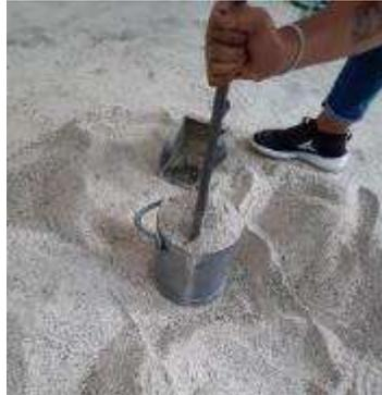
Ilustración 26. Varillado del material. Fuente: (Durán Ramos, 2021).
