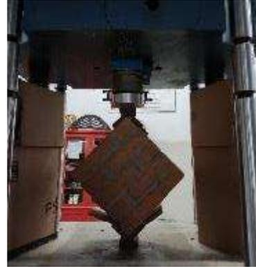
Ilustración 87. Aplicación de carga diagonal en murete con Máquina de pruebas Forney. Fuente: Foto propia.
