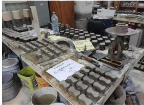
*Ilustración 93. Especímenes colados para las diferentes pruebas destructivas y no destructivas programadas. Fuente: Propia.*
