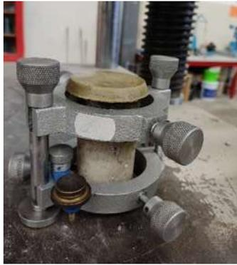
Ilustración 80. Colocación de anillos al espécimen cilíndrico a ensayar. Fuente: Propia.
