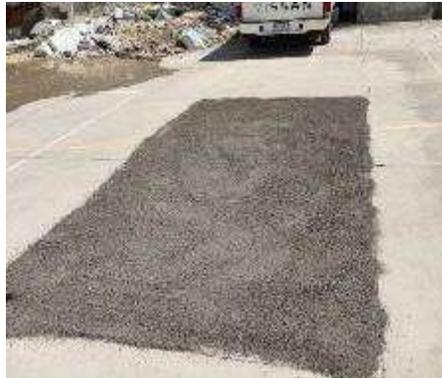
*Ilustración 8. Secado de agregado "Joyitas" en patio del Laboratorio de Materiales. Fuente: Propia.*
