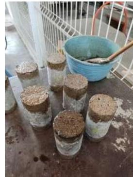
Ilustración 84. Engrasado de muestras para facilitar el retiro de cabeceo si adherirse al mortero. Fuente: Propia.
