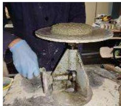
Ilustración 50. Palanca de fluidez dónde se hacen 25 giros en 15 segundos. Fuente: Propia.
