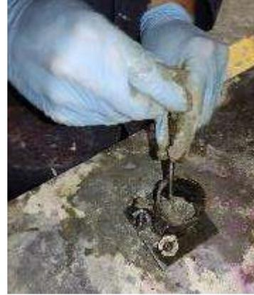
*Ilustración 65. Varillado en forma de espiral de 25 penetraciones. Fuente: Propia.*
