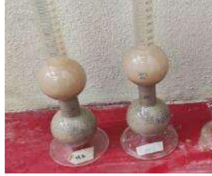
Ilustración 22. Llenado hasta nivel de aforo (450 ml). Fuente: Propia.
