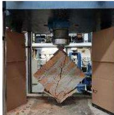
Ilustración 88. Murete fallado y probado a carga diagonal en Máquina Forney. Fuente: Foto propia.
