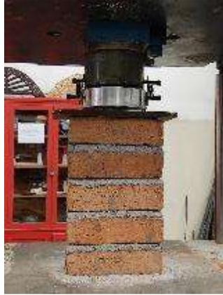
Ilustración 89. Pila centrada y nivelada en máquina Forney para su ensayo a compresión. Fuente: Foto propia.
