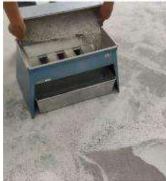
*Ilustración 11. Vaciado del agregado (Cuarteo). Fuente: (Mondragón Martínez, 2021).*
