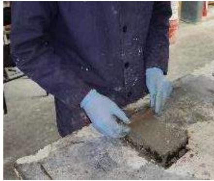
Ilustración 59. Enrasado con pisón de acrílico. Fuente: Propia.
