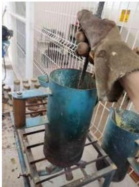
Ilustración 83. Calentamiento de azufre a temperatura óptima para cabeceo de especímenes cilíndricos. Fuente: Propia.
