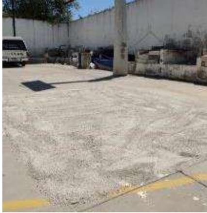
*Ilustración 7. Secado del agregado "El Coro" en patio del Laboratorio de Materiales. Fuente: Propia.*
