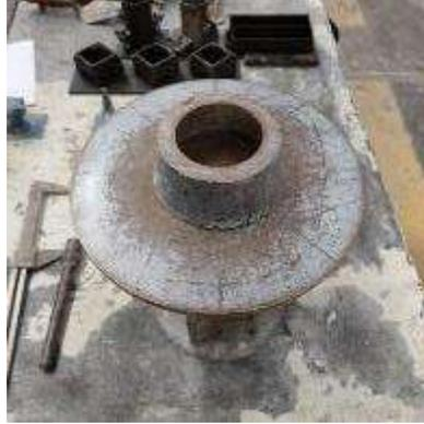
Ilustración 44. Mesa de fluidez en condiciones para utilizar. Fuente: Propia.
