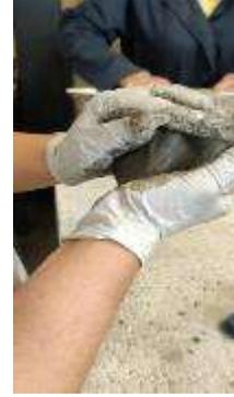
Ilustración 33. Amasado de la mezcla para su colocación en el molde. Fuente: (Mondragón Martínez, 2021).
