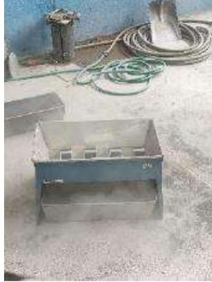
*Ilustración 9. Cuarteador en lugar seguro para comenzar el ensayo de muestreo. Fuente: (Mondragón Martínez, 2021).*
