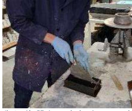
Ilustración 57. Agregado de primera capa de mortero. Fuente: Propia.
