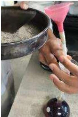
Ilustración 30. Agregado de cemento. Fuente: (Durán Ramos, 2021).
