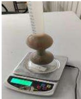
Ilustración 23. Registro de masa total del frasco. Fuente: (Durán Ramos, 2021).
