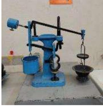
*Ilustración 77. Máquina para probar briquetas. Fuente: Foto propia.*
