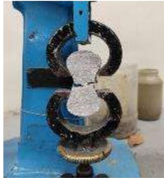
*Ilustración 79. Briqueta de mortero probada a tensión. Fuente: Foto propia.*
