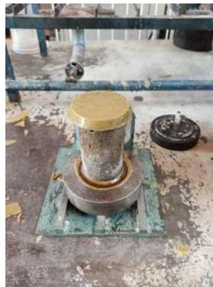
Ilustración 85. Especimen cilíndrico cabeceado con azufre. Fuente: Propia.
