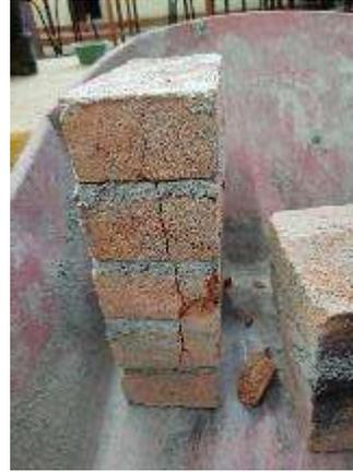
Ilustración 90. Pila fallada y probada a compresión. Fuente: Foto propia.
