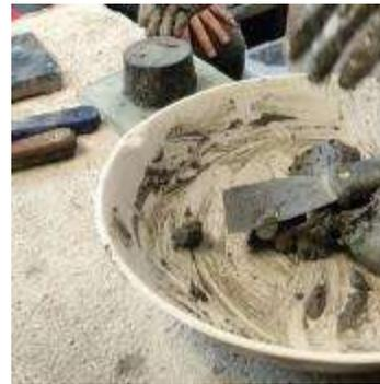
*Ilustración 38. Aparato de Vicat apoyado sobre cristal liso.
