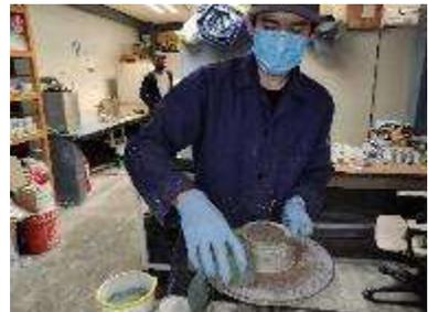
Ilustración 48. Limpieza de platillo para no afectar resultados de fluidez. Fuente: Propia.
