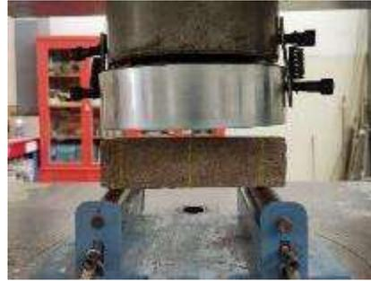
Ilustración 75. Colocación adecuada del prisma antes de la prueba. Fuente: Propia.
