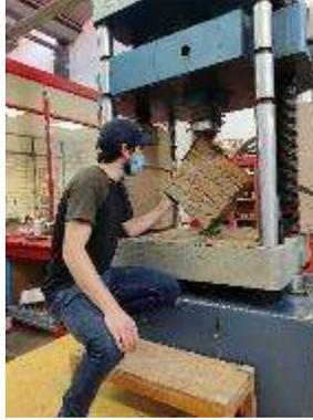
Ilustración 86. Colocación y centrado de murete en Máquina Forney. Fuente: Foto propia.
