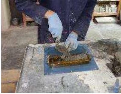
Ilustración 60. Llenado de molde con la mezcla de mortero. Fuente: Propia.
