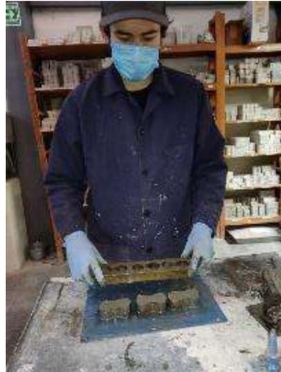
Ilustración 63. Retiro de molde en forma vertical. Fuente: Propia.
