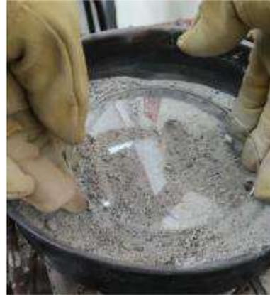
Ilustración 20. Uso de cristal para verificar humedad. Fuente: (Durán Ramos, 2021).
