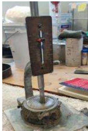
*Ilustración 39. Lectura de penetración del aparato de Vicat. Fuente: (Durán Ramos, 2021).*
