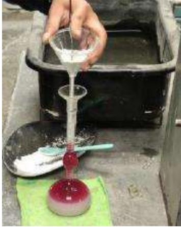
Ilustración 42. Vaciado de cal al frasco Le Chatelier.
