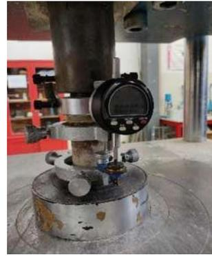
Ilustración 81. Colocación y centrado de la muestra a ensayar en la máquina universal de pruebas Forney. Fuente: Propia.
