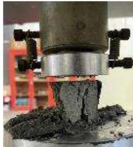
Ilustración 73. Muestra cubica fallada. Fuente: Propia.
