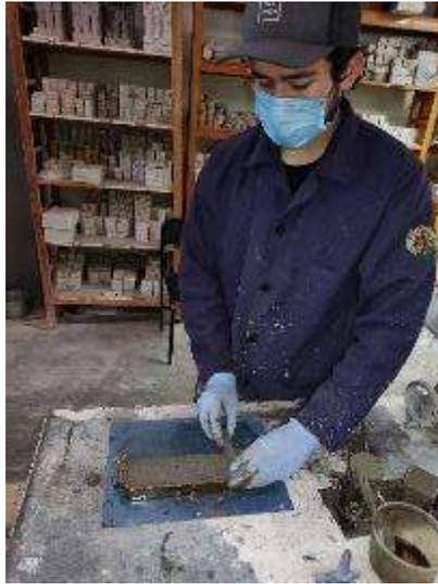
Ilustración 62. Enrasado de molde con pisón de acrílico. Fuente: Propia.
