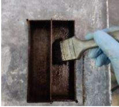
Ilustración 56. Aplicación de capa de aceite en el molde prismático. Fuente: Propia.
