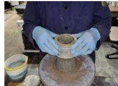
Ilustración 49. Se retira molde de forma vertical. Fuente: Propia.
