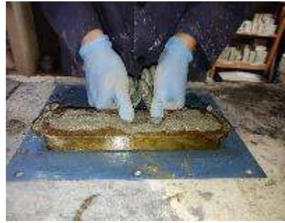
Ilustración 61. Compactación con pulgares de forma uniforme 12 veces. Fuente: Propia.
