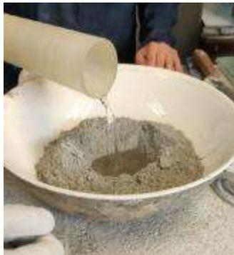
*Ilustración 37. Vertido de agua en el cemento.
