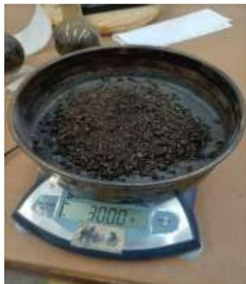
*Ilustración 12 Muestra de arena en estado natural*
