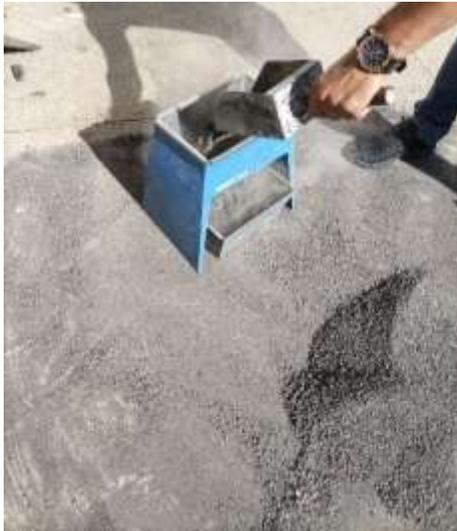
Se vuelve a introducir la porción de muestra de uno de los receptáculos al cuarteador cuantas veces sea necesario, hasta reducir la muestra al tamaño requerido para la prueba programada.
