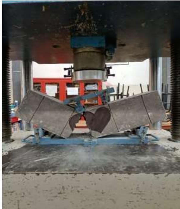
*Ilustración 60 Prueba de flexión en vigas*
