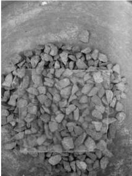
*Ilustración 24 Colocación del vidrio para verificar que la muestra de grava está completamente seca*
