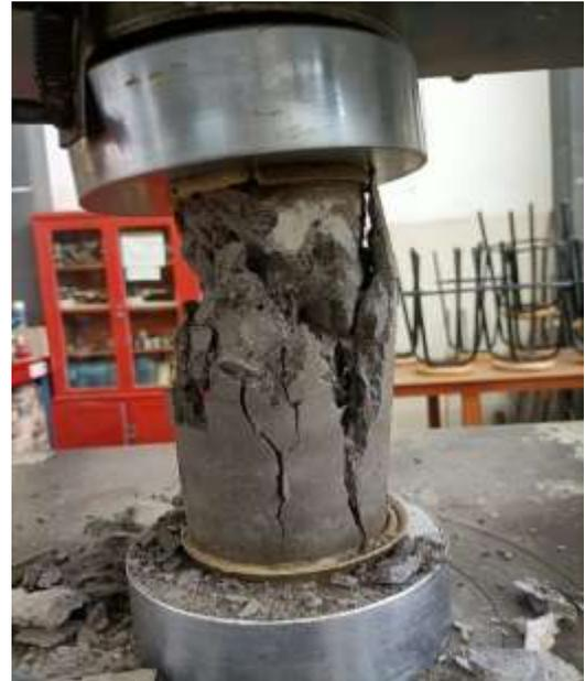
*Ilustración 54 Ruptura de espécimen de concreto por efecto de la compresión*
