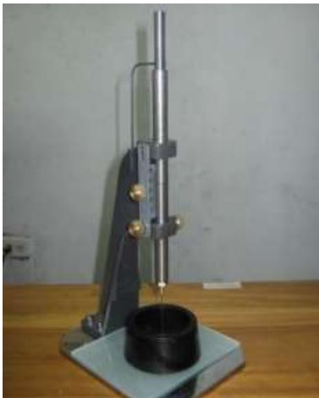
Se deja caer la aguja sobre la superficie de la pasta de cemento, se dejan pasar 30s y se toma la lectura de penetración de la aguja, si la lectura es de  $10 \text{ mm} \pm 1 \text{ mm}$ , se toma esa cantidad de agua como la necesaria para obtener la consistencia normal del cemento (si la lectura no es de  $10 \text{ mm} \pm 1 \text{ mm}$ , se repite el procedimiento antes visto hasta conseguir la cantidad de agua necesaria para obtener la consistencia normal del cemento).
