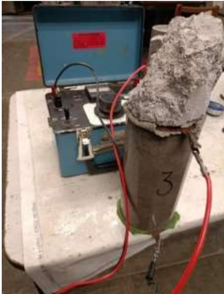
*Ilustración 51 Prueba de resistividad eléctrica en laboratorio.*
