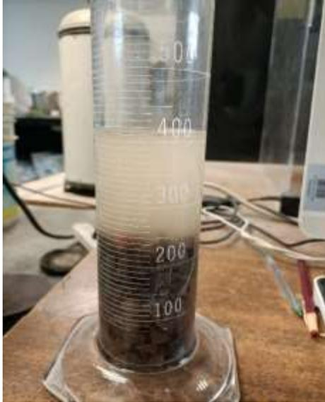
Se llena el picnómetro hasta el nivel del orificio con agua, se coloca en una superficie plana y se procede a colocar la muestra de grava dentro, recibiendo el agua desalojada con una probeta graduada. Cuando se haya terminado de colocar la grava dentro del picnómetro esperamos a que escurra el agua desalojada y tendremos en la probeta el volumen del agua que corresponde al volumen (V) de las partículas de grava.
