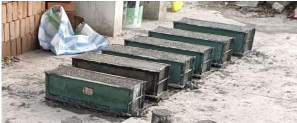
*Ilustración 37 Colado de especímenes prismáticos.*
