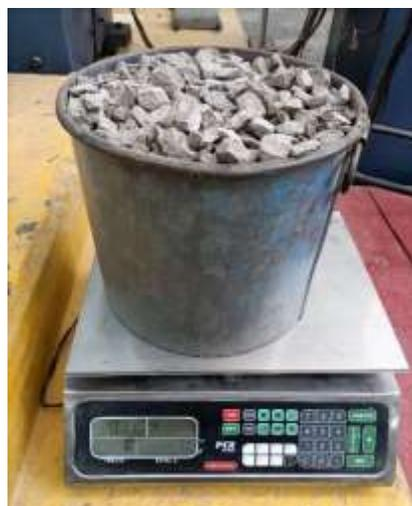
*Ilustración 32 Determinando la masa total del recipiente lleno y enrasado*
