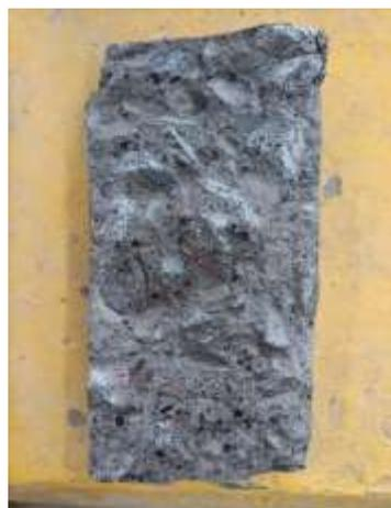
*Ilustración 56* Espécimen partido a la mitad por acción de la Tensión.
