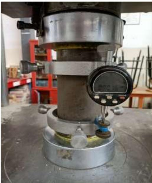
*Ilustración 58 Determinación del módulo de elasticidad estático*
