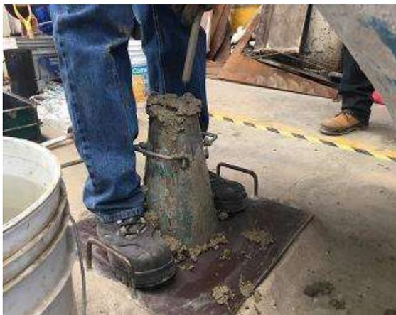
*Ilustración 41 Llenado y compactado del cono Abrams*
