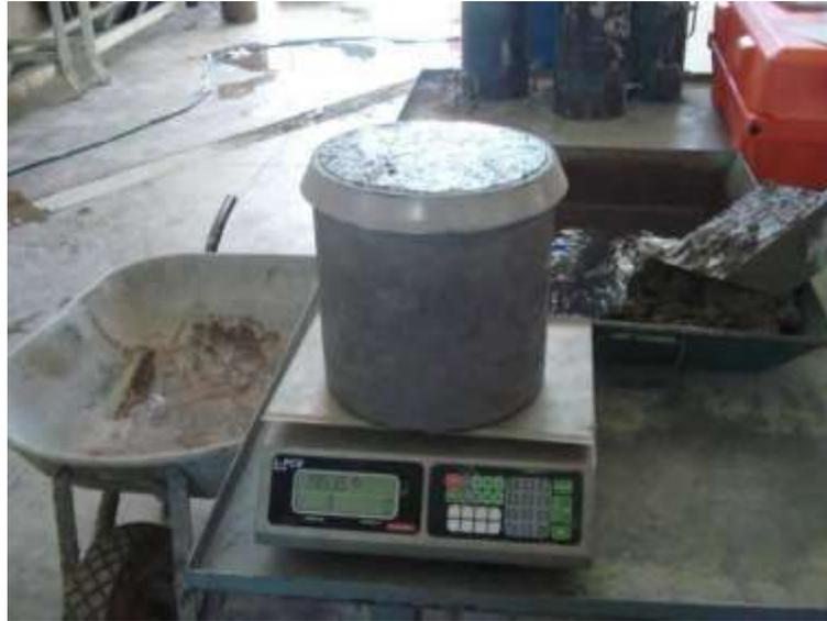
*Ilustración 42 Determinación de la masa unitaria en el concreto fresco.*
