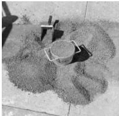
*Ilustración 17 Arena enrasada en molde metálico.*
