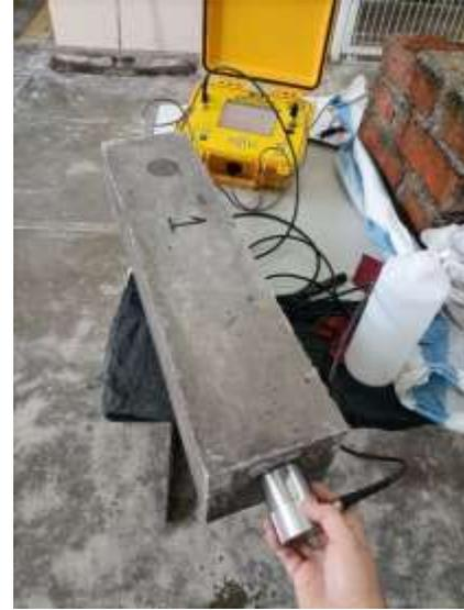
*Ilustración 47 Prueba de velocidad de pulso ultrasónico en vigas*
