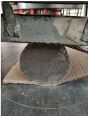
*Ilustración 57* Ruptura del espécimen por carga diametral o Tensión indirecta
