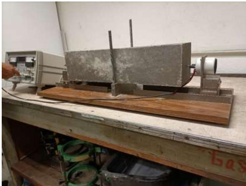
*Ilustración 52 Determinación de la frecuencia de resonancia por medio de ondas longitudinales.*
