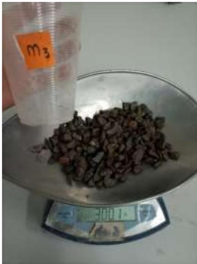
*Ilustración 26 Muestra de grava que pasó la malla 3/4" y se retuvo en la malla 3/8" en estado saturado y superficialmente seco.*
