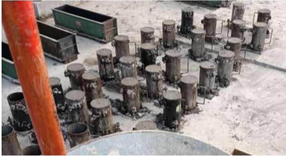
*Ilustración 36 Elaboración de especímenes de concreto*
