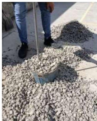
*Ilustración 31 Llenado y varillado del molde con la grava seca*
