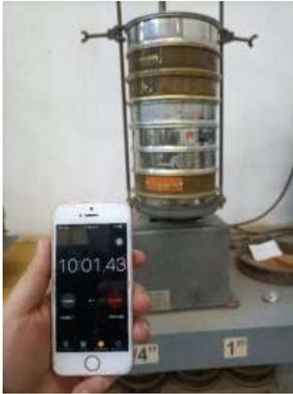
Para esta prueba se dejó la muestra cribar por medios mecánicos durante 15 minutos.
