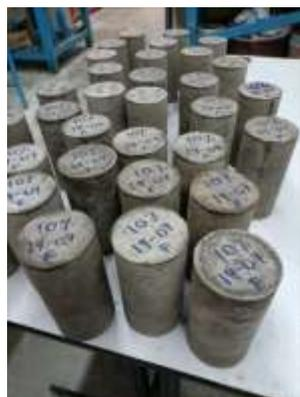
*Ilustración 44 Etiquetado de los especímenes*
