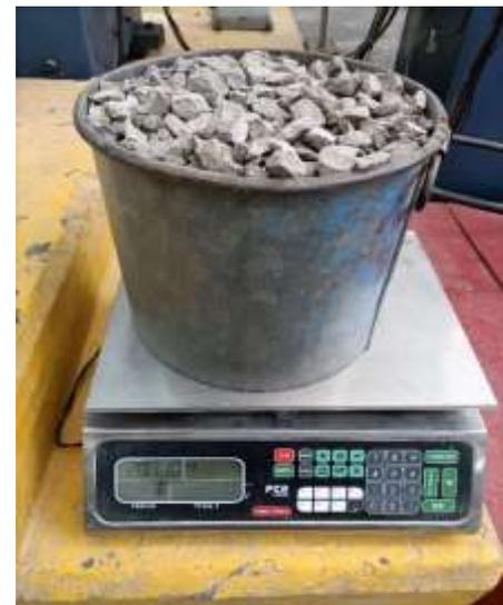
*Ilustración 29 Determinación de la masa total de la muestra*
