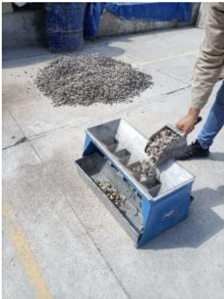
*Ilustración 23 A un lado se aprecia la muestra representativa de grava, al centro se observa el cuarteador mecánico.*
