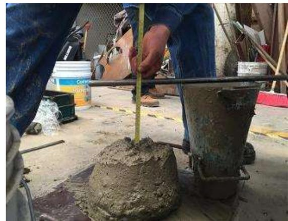
*Ilustración 40 Medición del revenimiento*
