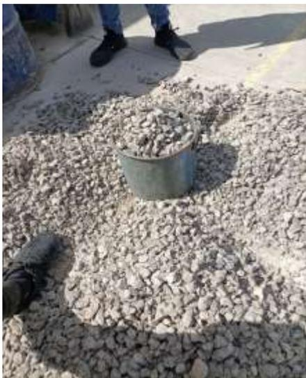
*Ilustración 30 Llenado del molde con la grava suelta*
