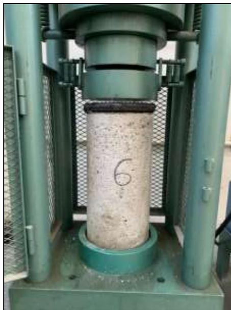
*Figura 51.- Muestra No.6, antes de aplicar carga a compresión. (23/Mayo/2022)*
