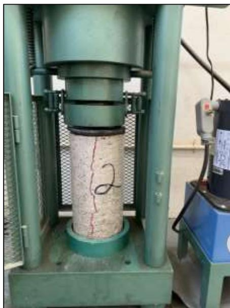
*Figura 44.- Muestra No.2, Fisura producto de la carga máxima aplicada. (23/Mayo/2022),*
