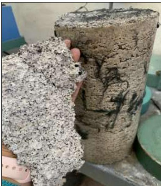
Figura 64.- Falla de la muestra No.4 después de la rehabilitación y curado. (9/Junio/2022)
