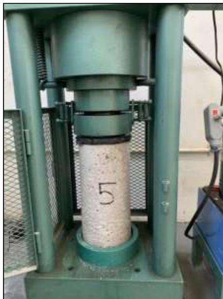
*Figura 49.- Muestra No.5, antes de aplicar carga a compresión. (23/Mayo/2022)*
