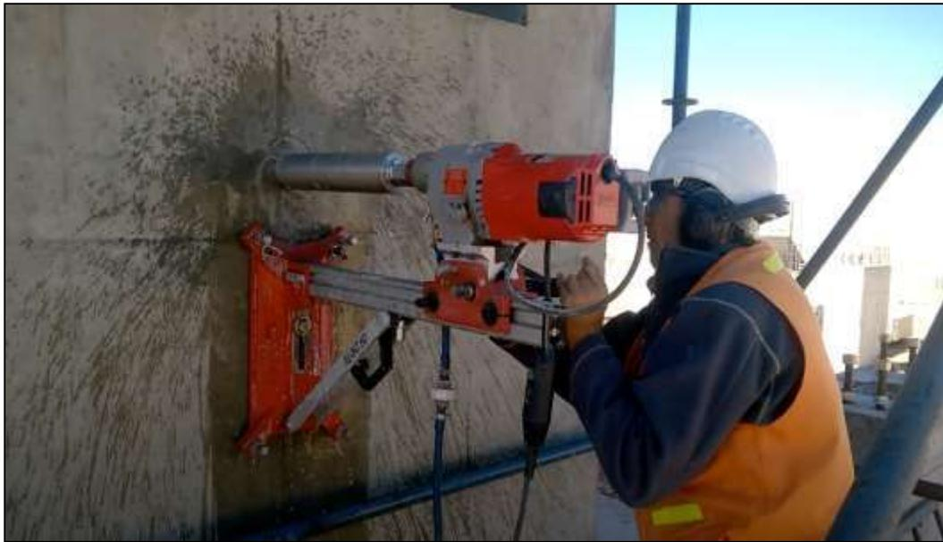
Figura 12.- Proceso de extracción del corazón, en una estructura de concreto.
