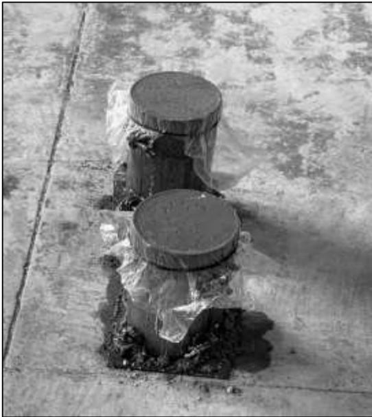
*Figura 9.- Cilindros colados en obra, cubiertos en la parte superior de plástico, para conservar humedad. (20/enero/2022)*
