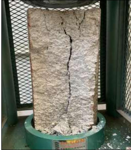
*Figura 60.- Interior de la muestra No.1, donde se observa que no hay penetración de resina poliéster en su interior. (9/Junio/2022)*
