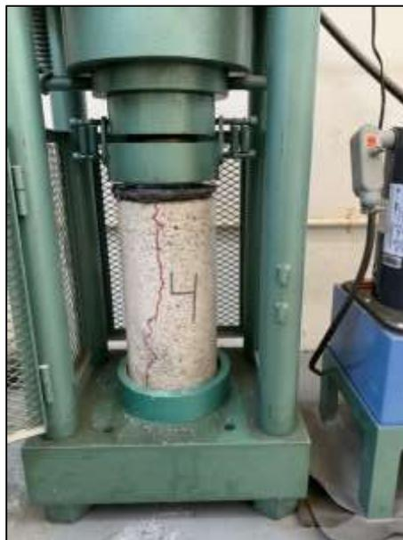
*Figura 48.- Muestra No.4, fisura producto de la carga máxima aplicada. (23/Mayo/2022)*
