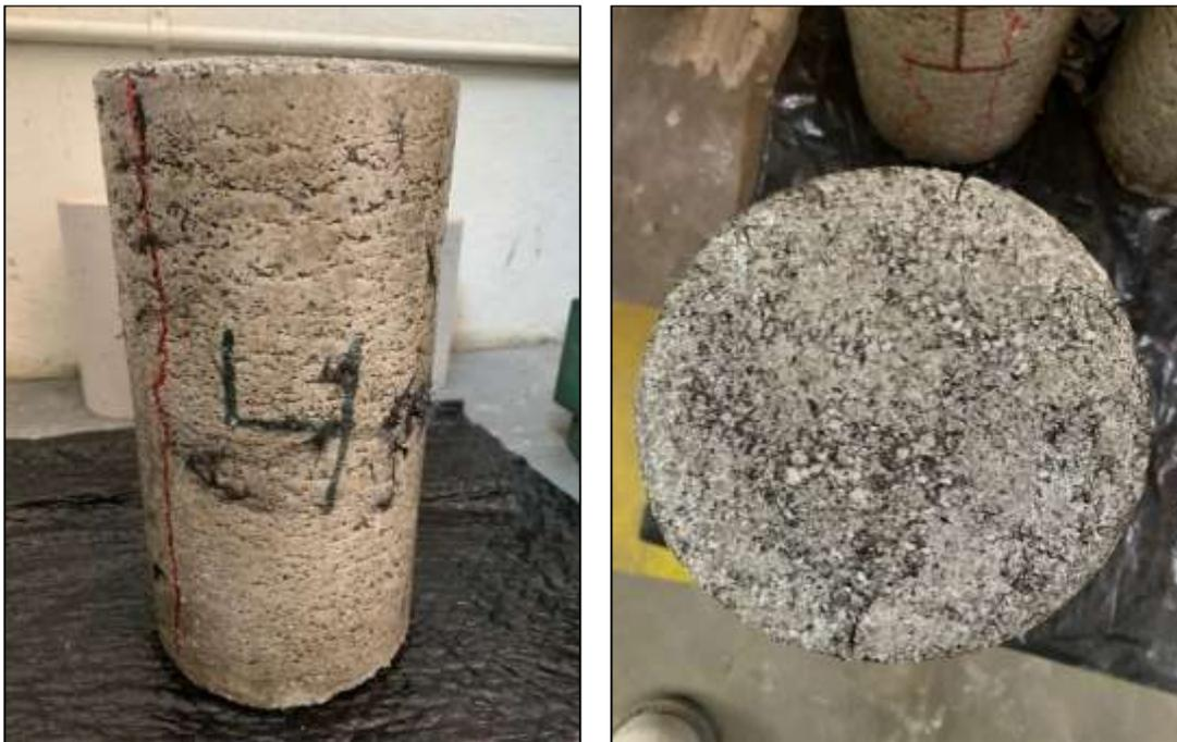
Figura 63.- Muestra No. 4 rehabilitada con la primera capa de resina poliéster y fibra de carbono. (9/Junio/2022)
