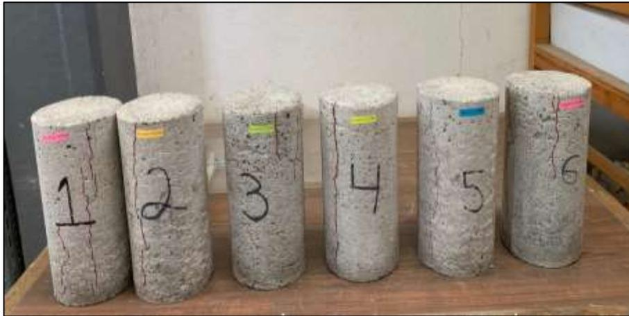
Figura 53.- Muestras después de la carga máxima aplicada. (23/Mayo/2022)
