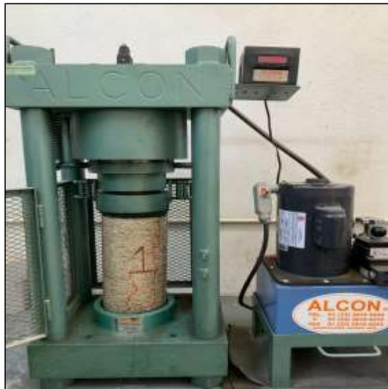
*Figura 58.- Muestra No.1 después de la carga aplicada de compresión simple.*
