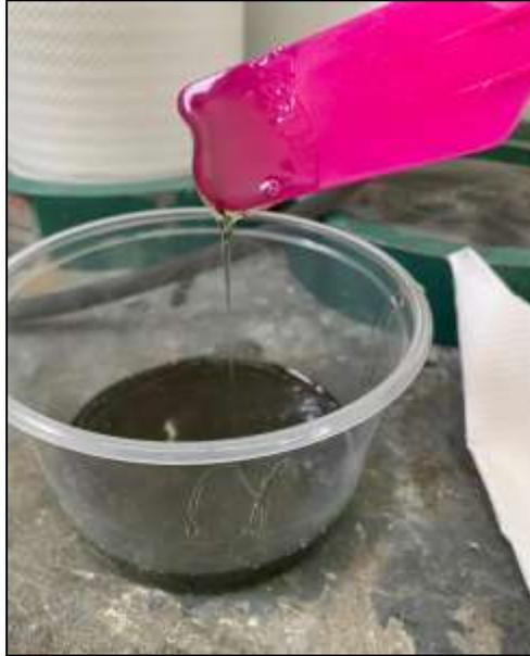
*Figura 56.- Consistencia de la resina mezclada con el catalizador. (9/Junio/2022)*
