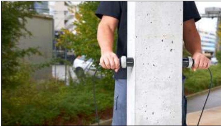
*Figura 8.- Proceso de medición de la propagación de la velocidad de la energía a través del concreto.*
