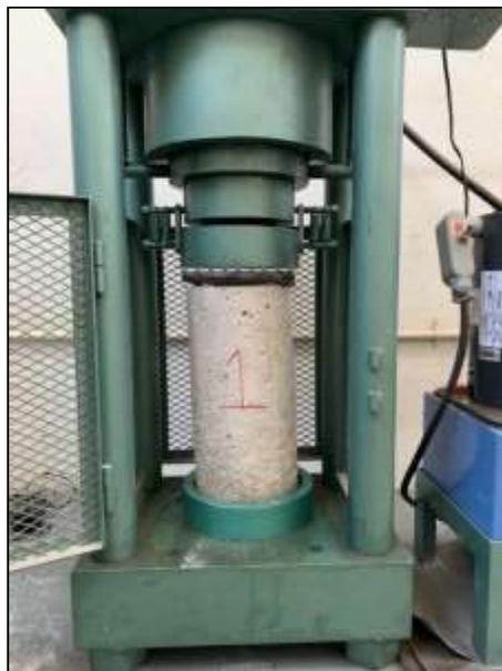
Figura 6.6.1.1. Espécimen No. 1, antes de aplicar carga a compresión (23/Mayo/2022),
