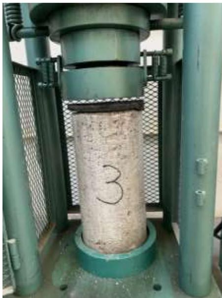
*Figura 45.- Muestra No.3, antes de aplicar carga a compresión. (23/Mayo/2022),*
