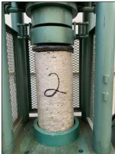
*Figura 43.- Muestra No.2, antes de aplicar carga a compresión. (23/Mayo/2022)*
