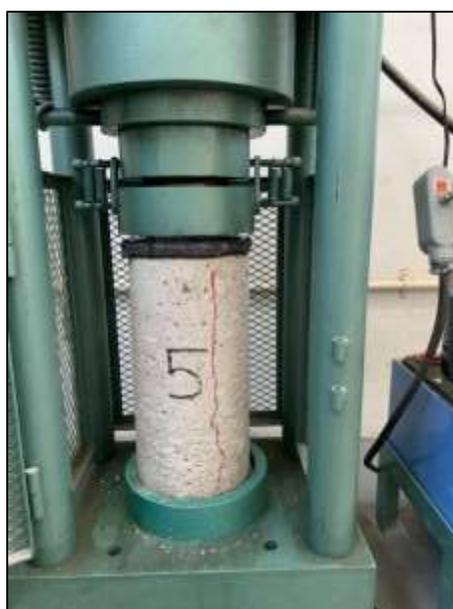
*Figura 50.- Muestra No.5, fisura producto de la carga máxima aplicada. (23/Mayo/2022)*
