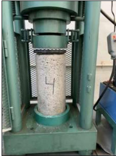
*Figura 47.- Muestra No.4, antes de aplicar carga a compresión. (23/Mayo/2022)*
