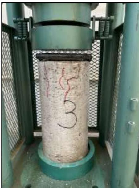
*Figura 46.- Muestra No.3, fisura producto de la carga máxima aplicada. (23/Mayo/2022)*
