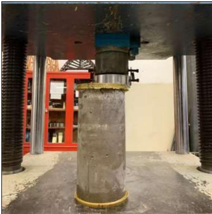
*Figura 10.- Cilindro cabeceado con azufre, listo para ser probado por compresión. (17/febrero/2022)*
