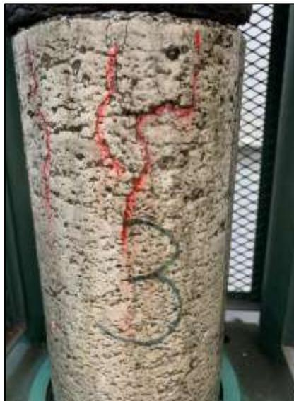
*Figura 59.- Muestra No.3 después de la carga aplicada de compresión simple. (9/Junio/2022)*
