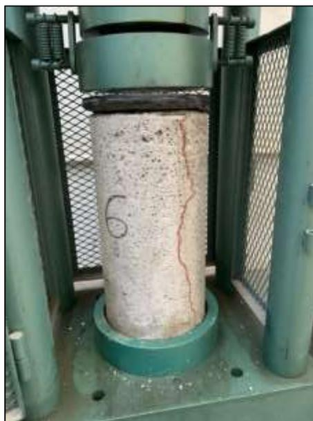
*Figura 52.- Muestra No.6, fisura producto de la carga máxima aplicada. (23/Mayo/2022)*
