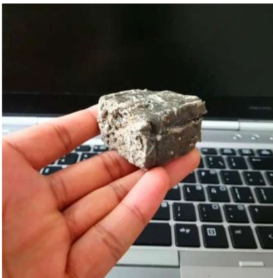
Figura 7.- Primera muestra solidificada de resina de pino perteneciente a la mezcla 3 que contempla: resina de pino + arena + cal.
