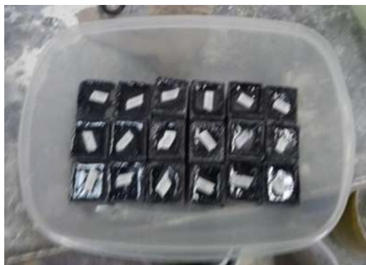
Figura 37.- Colocación de los especímenes en un contenedor de plástico y con tapa para evitar la evaporización del sulfato de sodio
