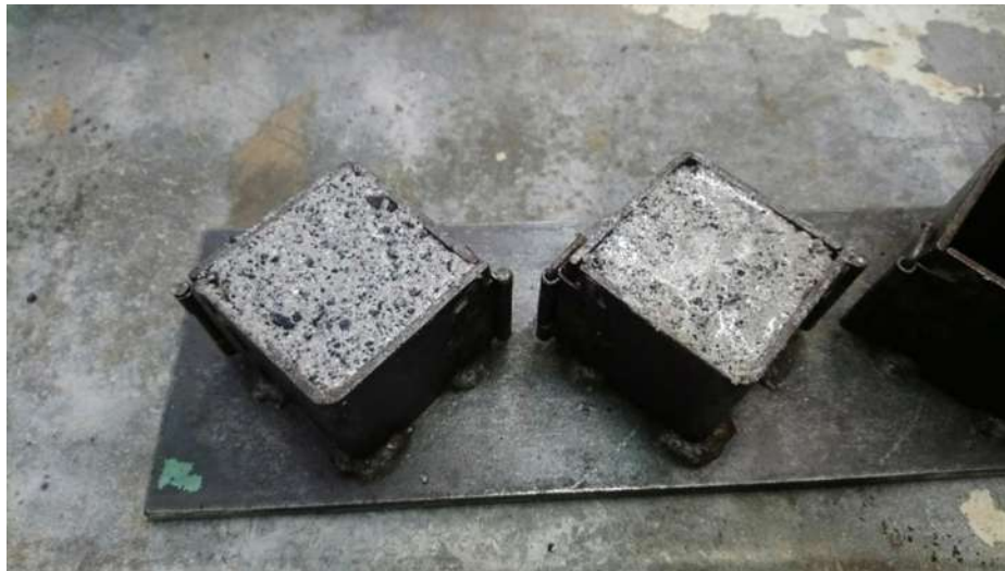
Figura 8.- Se puede observar la superficie húmeda a los pocos minutos después de colar.
