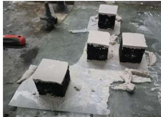
Figura 29.- Cabeceado de especímenes con yeso.
