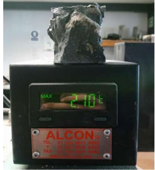
Figura 24.- Carga soportada en la prensa hidráulica ya solidificada el espécimen
