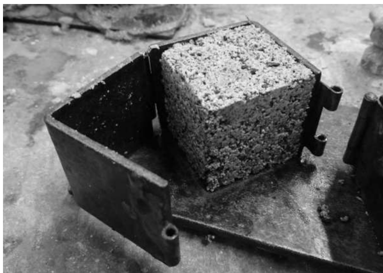
Figura 9.- Pasado una hora el material ya contaba con un endurecimiento el cual permitía que se desmoldara fácilmente sin perder su estado físico.
