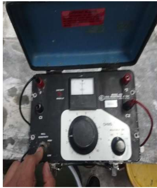
Figura 35.- Lecturas arrojadas por el equipo de resistividad eléctrica.
