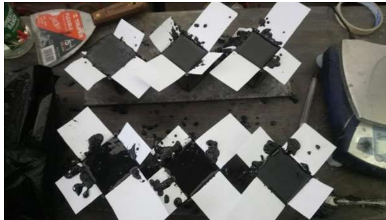
Figura 30.- Mezclas cubiertas de papel con la función que nuestro polímero no se adhiera a las paredes del molde.
