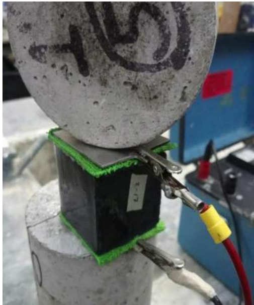
Figura 34.- equipo conectado para la lectura de resistividad eléctrica.
