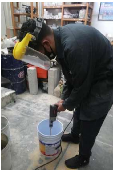
Figura 36.- mezclado constante con intervalos para evitar el sobrecalentamiento del sulfato de sodio.
