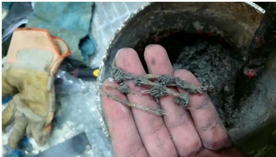
Figura 15.- Fibras que se obtuvieron a partir de la resina de pino y su choque térmico con la mezcla de mortero.
