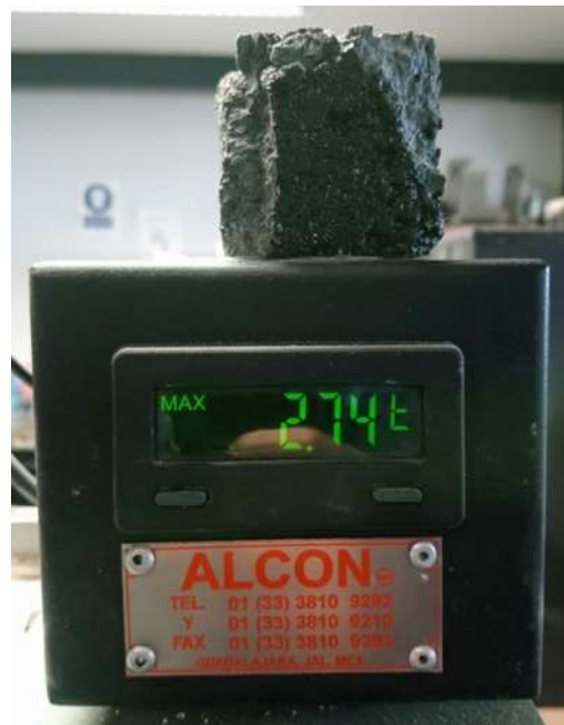
Figura 27.- Mezcla M27 después de haber sido probada en la prensa hidráulica.
