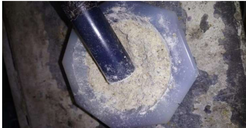
Figura 16.- Molienda de la brea de pino.
