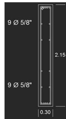
Figura 82. Refuerzo longitudinal
