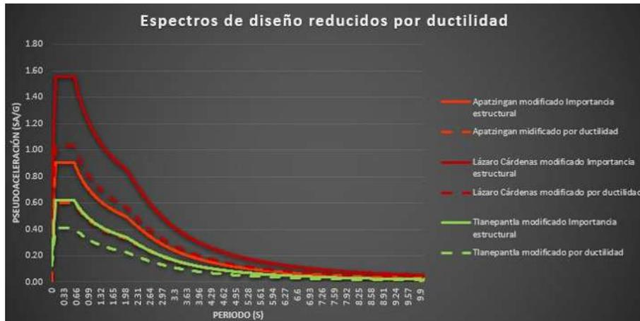
Figura 70. Espectros de diseño de estructuras del grupo A con los espectros de diseño reducidos por ductilidad
