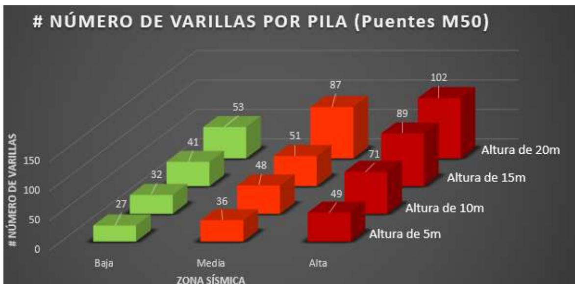
Figura 106. Comparación del número de varillas por pila para los modelos de puentes M50
