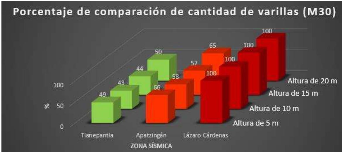
Figura 107. Comparación de cantidad de varillas por pila en porcentaje (M30)
