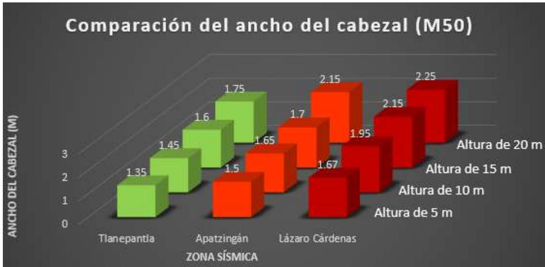
Figura 109. Comparación de los anchos de los cabezales para los modelos M50
