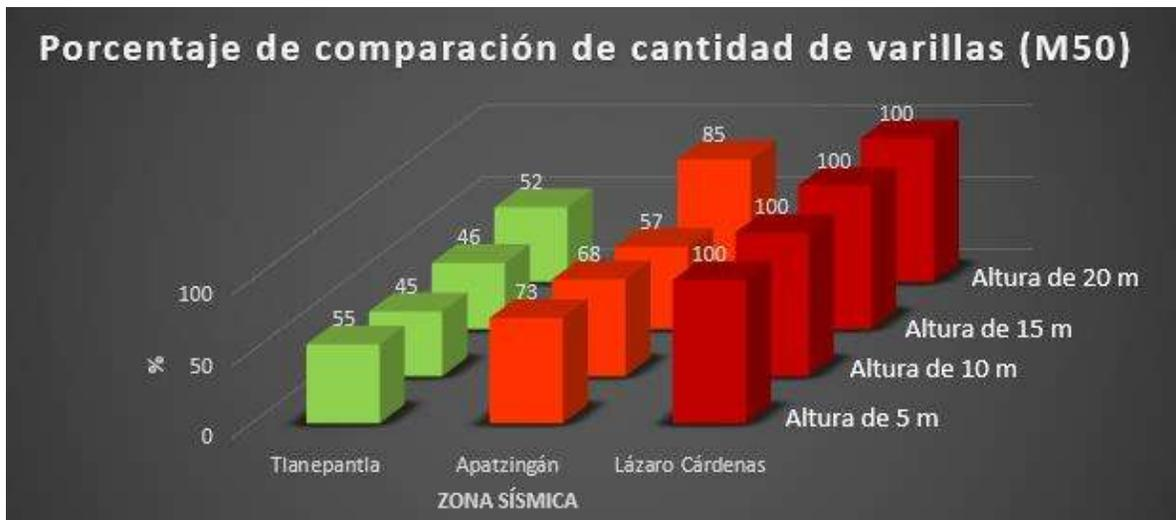
Figura 108. Comparación de cantidad de varillas por pila en porcentaje (M50)
