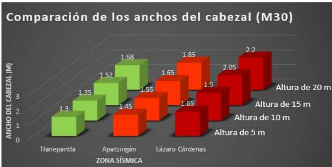
Figura 110. Comparación de los anchos de los cabezales para los modelos M30
