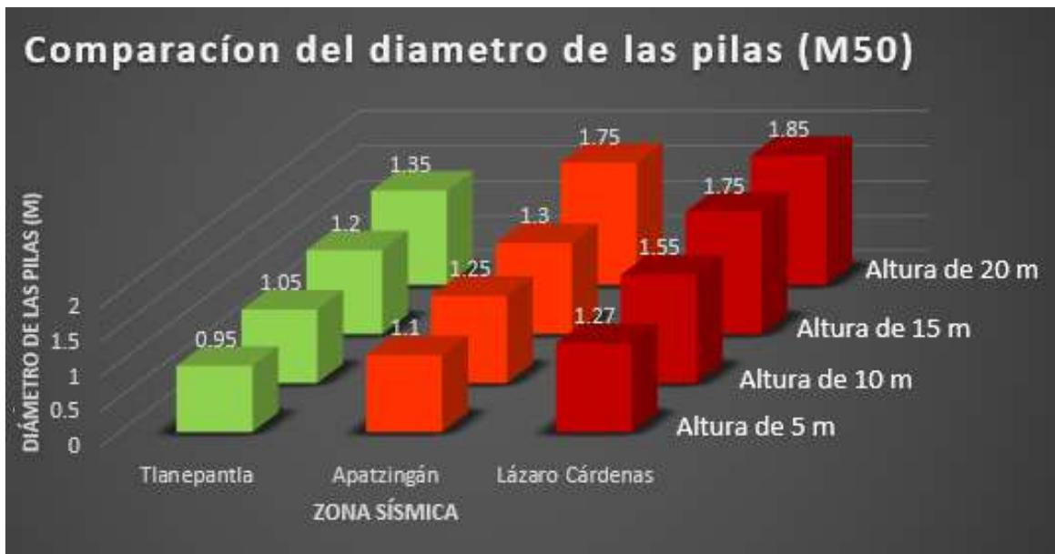
Figura 104. Comparación del diámetro de las pilas M50
