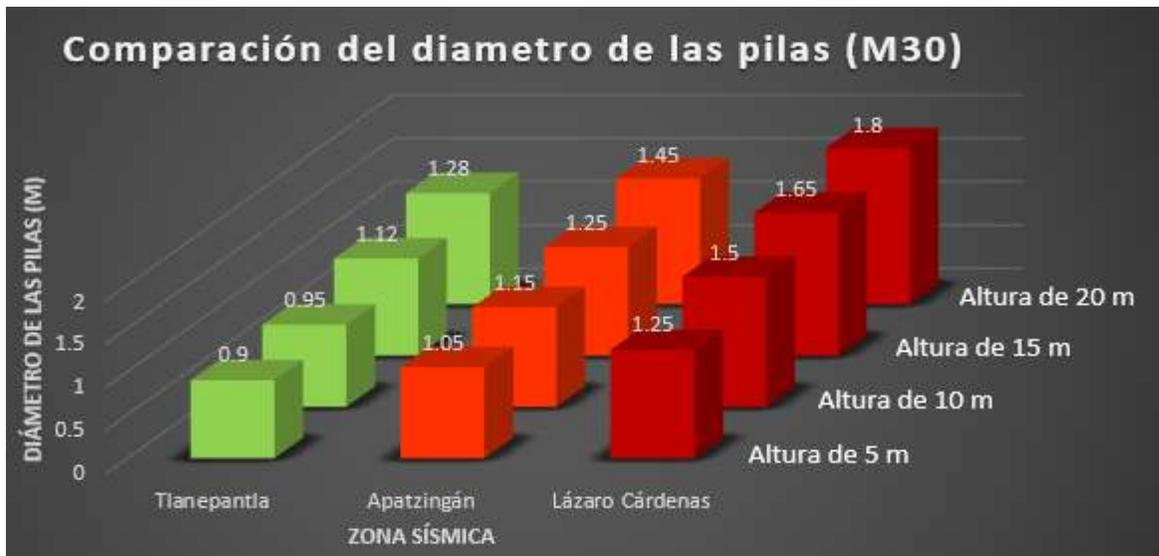
Figura 103. Comparación de los diámetros de las pilas M30
