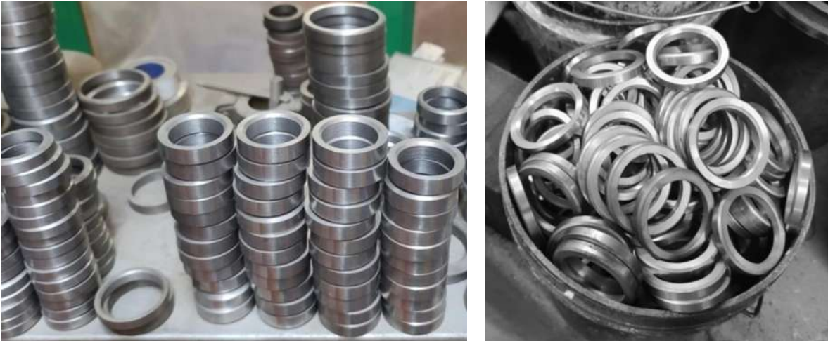
Figura 7.38 Asientos de válvula posterior del cortado.
