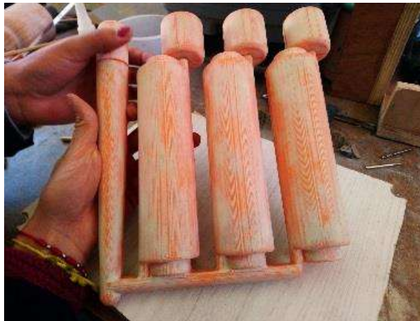
Figura 7.12 Modelo de impresión 3D después del proceso de empastado y lijado.
