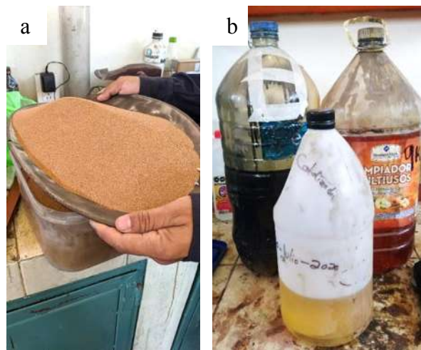
Figura 6.4 a) Arena de sílica, b) Resinas autofraguantes y catalizador, utilizados para la fabricación de los moldes.
