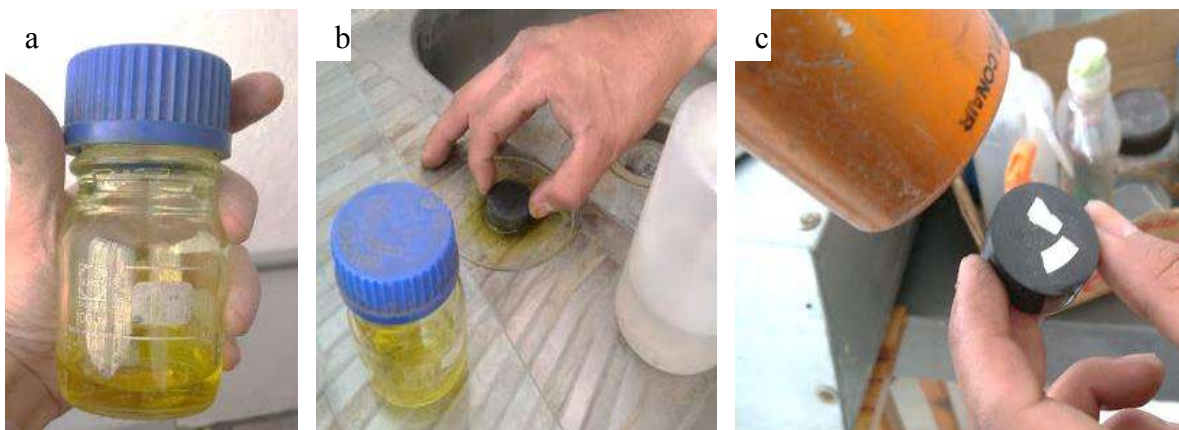
Figura 6.12 a) Reactivo Villela, b) Muestras siendo atacadas con el reactivo Villela, c) Secado de las muestras después de ser lavadas con agua y alcohol.
