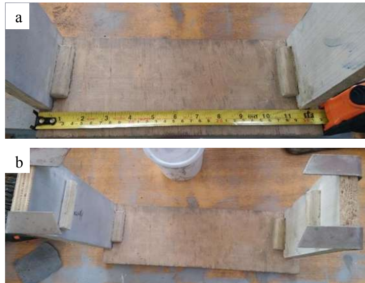
Figura 7.20 a) Medida de la tabla inferior, b) Caja ya armada vista desde arriba.
