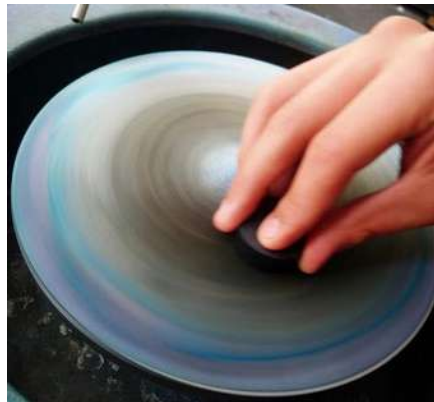
Figura 6.11 Pulido con pasta de diamante de 1 \mu\text{m} .
