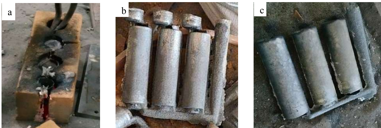
Figura 7.26 a) Desmoldeo de las barras huecas, b) Barras huecas ya extraídas del molde de arena, c) Barras huecas obtenidas de la fundición.
