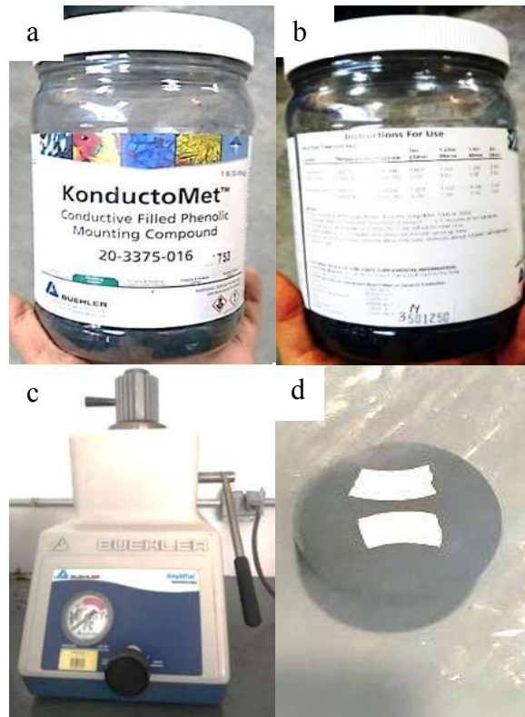
Figura 6.9 a) Frasco de baquelita conductora, b) Instrucciones de uso de la baquelita, c) Prensa de montaje de la marca Buehler, d) Muestras montadas en la baquelita.
