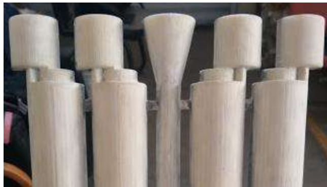
Figura 7.18 Modelo de 4 barras huecas donde se muestra el sistema de alimentación y las uniones entre las barras huecas.
