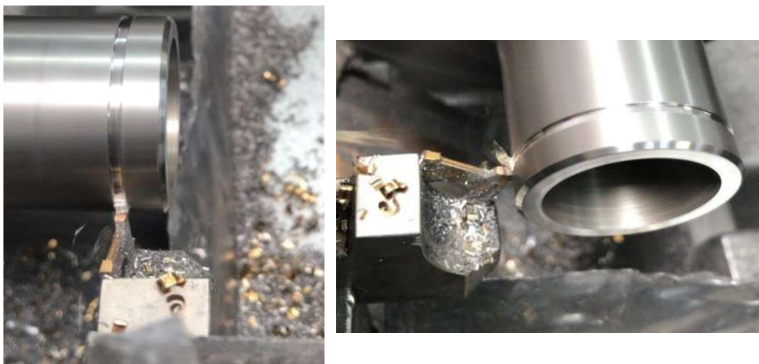
Figura 7.37 Anillo de la aleación 3 siendo tronzado en empresa DOMEX.
