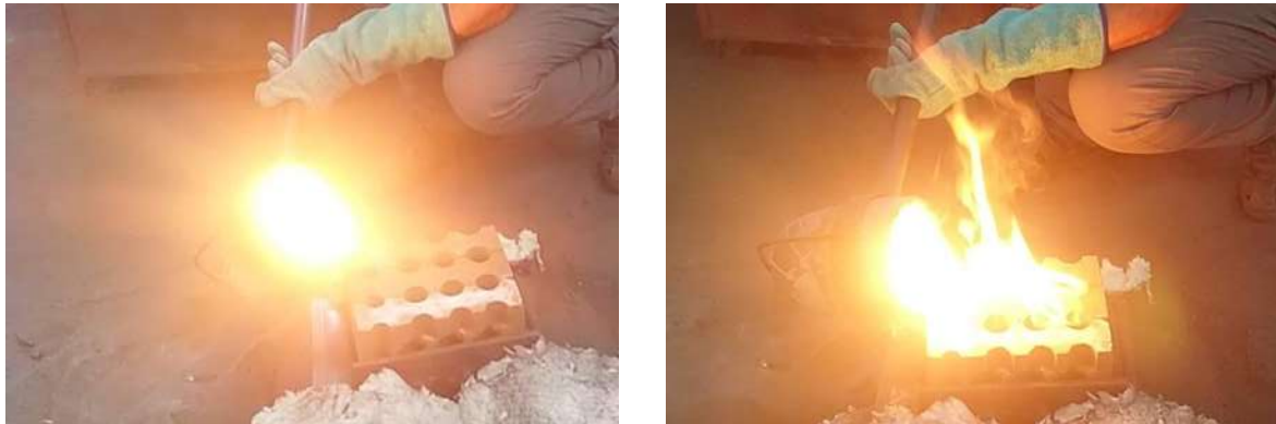
Figura 7.25 Vaciado del metal fundido en el molde de las barras huecas.
