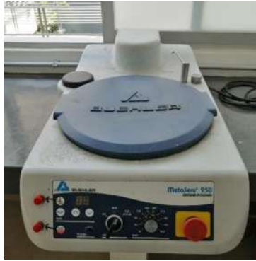
Figura 3.11. Pulidora Marca Buehler modelo Ecomet 3 utilizada para el pulido de las muestras con paño de nylon y pasta de diamante.
