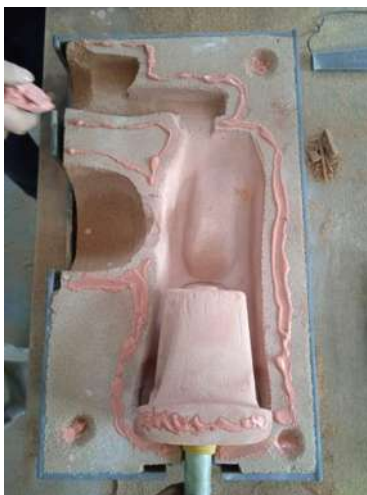
Figura 4.17. Molde de la punta de excavadora con pegamento de corazones.
