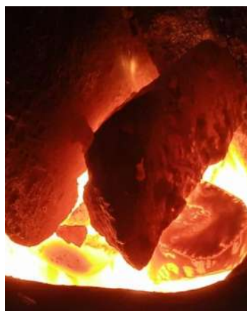
Figura 4.21. Horno cargado con acero durante el proceso de fundición.
