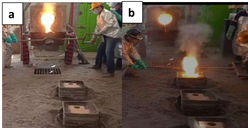
Figura 4.22. a) Proceso de vaciado del acero desde el horno de inducción al crisol y b) proceso de vaciado del crisol a los moldes de arena.
