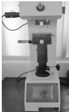
Figura 3.12. Microdurómetro para la medición de microdureza Vickers.
