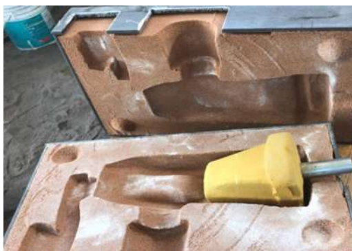
Figura 4.16. Molde terminado para punta de excavadora con corazón de arena Shell.
