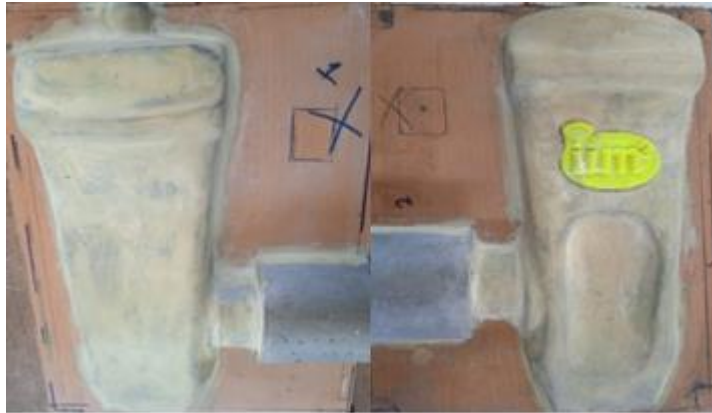
Figura 4.11 Modelo de la punta en dos partes atornillado en una tabla de madera.
