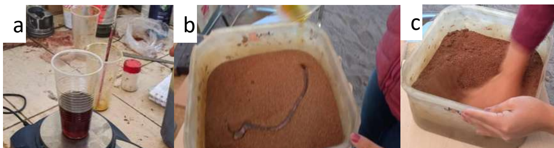
Figura 4.14. a) Mezcla del componente A y C, b) la resina se le agrega a la arena, c) mezcla de la resina y la arena.
