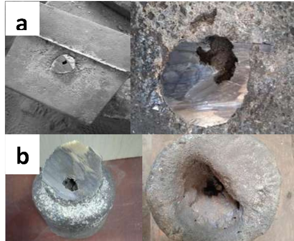
Figura 4.26. a) Porosidad dentro de la pieza y b) porosidad dentro de la mazarota.
