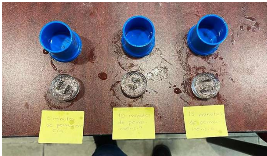
Figura 3.12 Encapsulamiento de las uniones cortadas transversalmente en los tres tiempos de permanencia.
