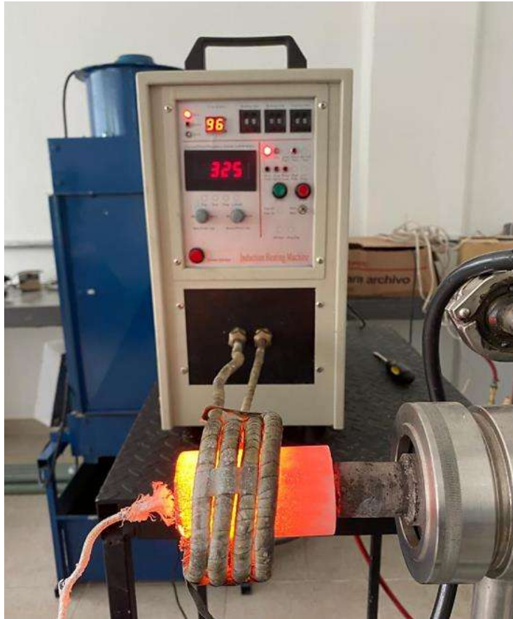
Figura 3.10 Horno de inducción Induction Heating Machine.
