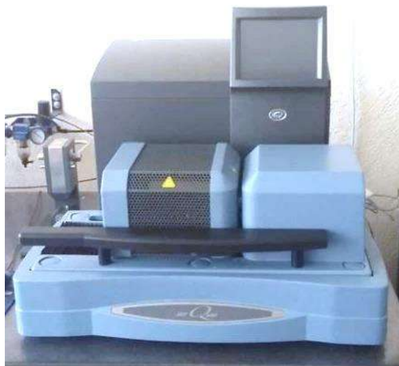
Figura 3.3 Equipo DSC-TGA modelo SDT Q600.
