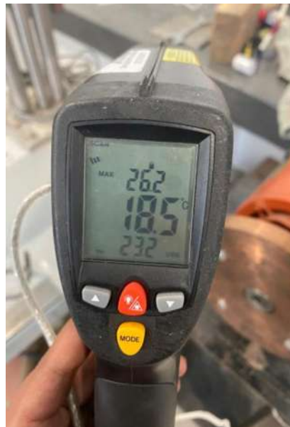
Figura 3.9 Termómetro infrarrojo digital de la marca CEM modelo DT-8869.
