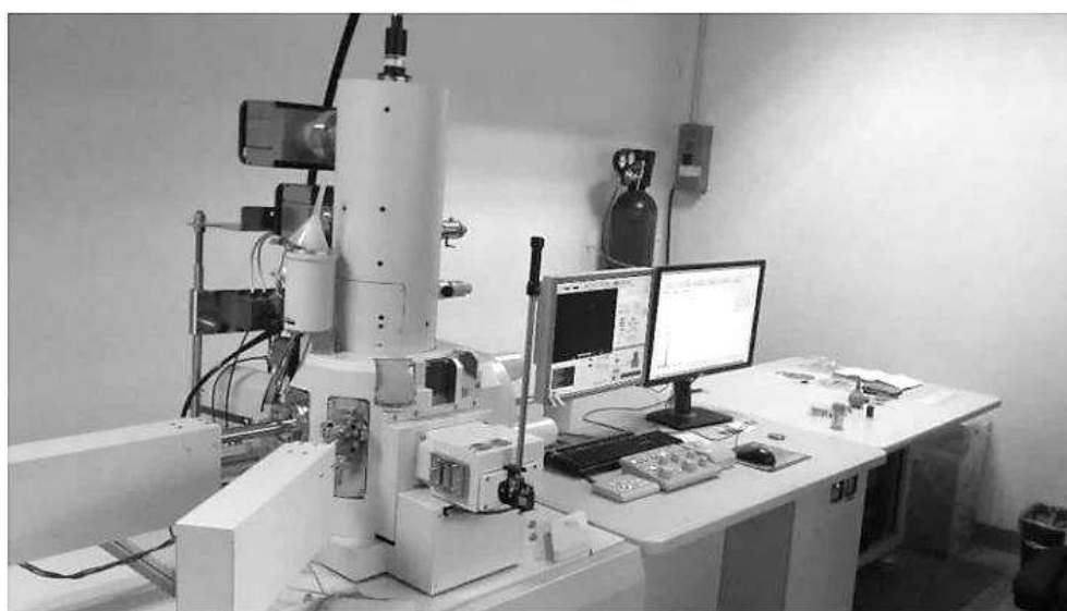
Figura 3.2 Microscopio electrónico de barrido JEOL JSM-7600F.
