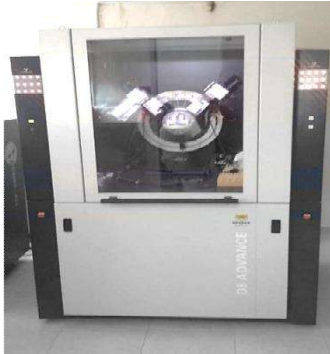
Figura 3.5 Difractómetro de rayos X D8 ADVANCE DAVINCI.
