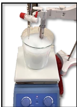
Figura 4. Síntesis de hidroxiapatita por el método de precipitación
