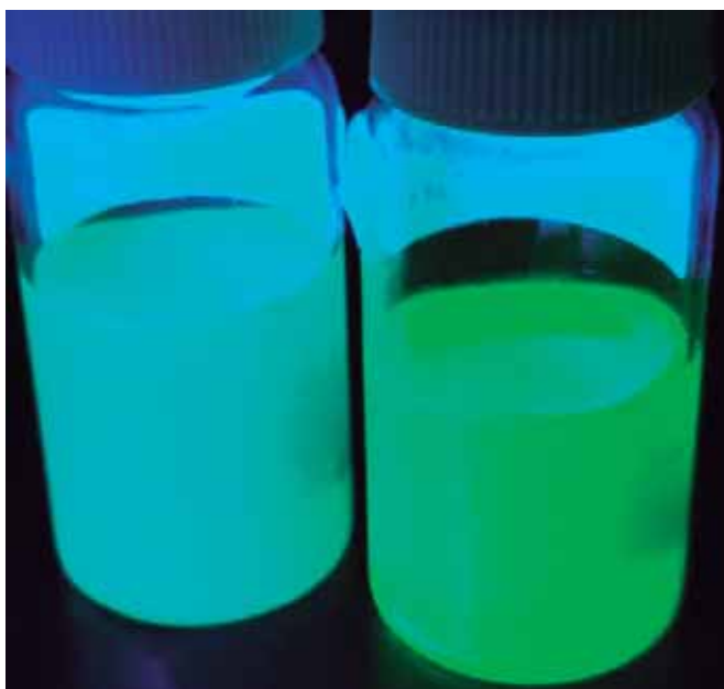
Figura 4.4 Comparación de puntos cuánticos de perovskitas de \text{CsPbBr}_3 puro (izquierda) y dopado (derecha) excitados con lámpara en una longitud de onda 370 nm.
