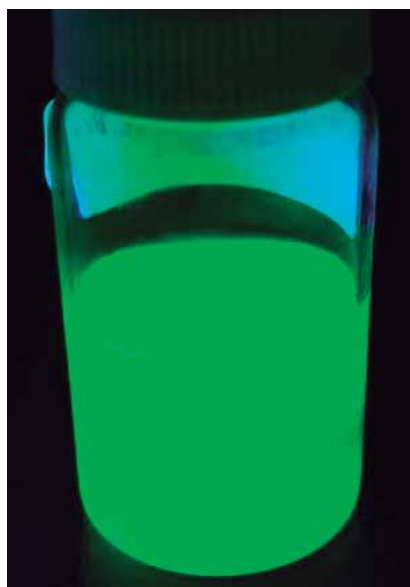
Figura 4.3 Puntos cuánticos de perovskita dopado con \text{CsPbBr}_3 con \text{EuCl}_3 , excitados con lámpara UV, con una longitud de onda 370 nm.
