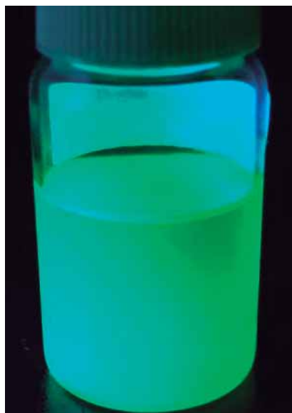
Figura 4.2 Puntos cuánticos de perovskita \text{CsPbBr}_3 sin dopar, excitados con luz UV, con una longitud de onda de 370 nm.
