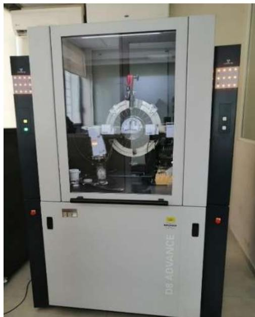
**Fig. 17** Difractor de Rayos-X marca Bruker® modelo D8 Advance Davinci.
