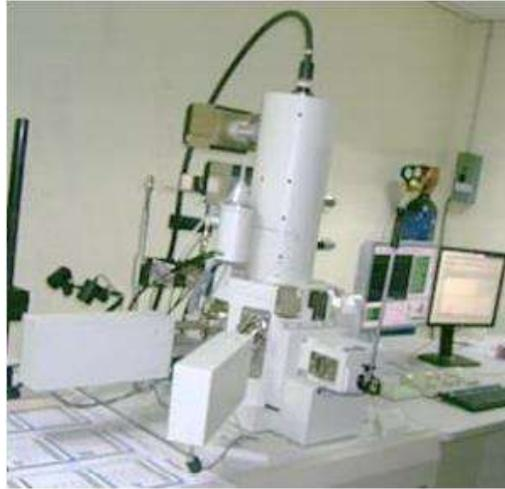
**Fig. 16** Microscopio electrónico de barrido marca Jeol modelo 7600.
