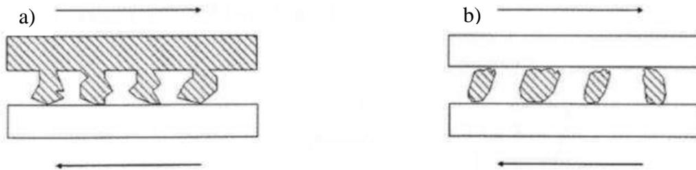
**Fig. 2** Tipos de abrasión. a) Abrasión de dos cuerpos y b) Abrasión de tres cuerpos.
