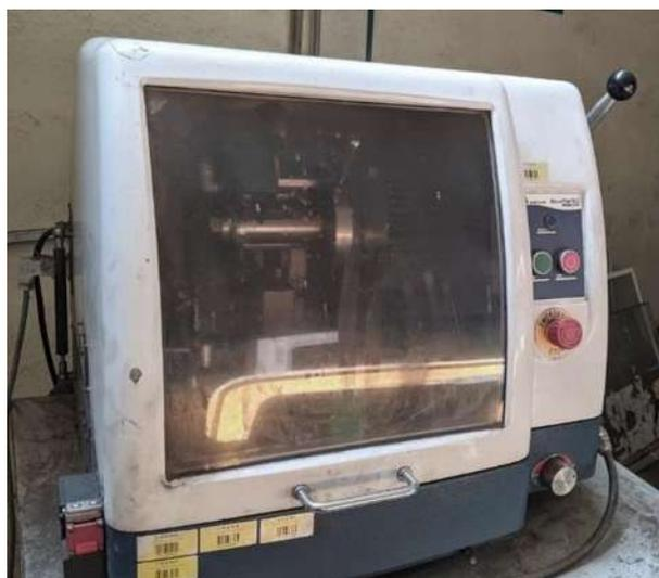
**Fig. 12** Cortadora metalografica Buehler® modelo AbrasiMet 250.
