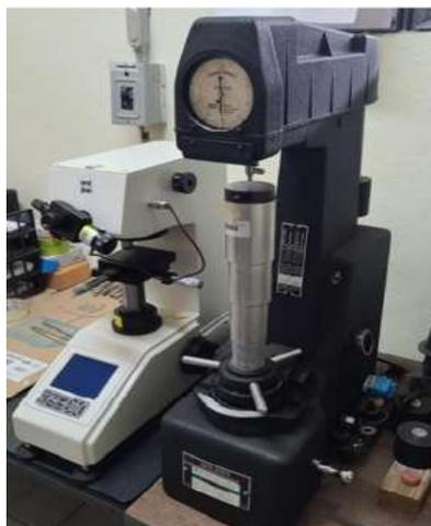
**Fig.23** Durómetro para la medición de dureza HRC.
