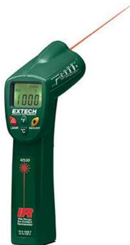
Figura 16. Termómetro con puntero laser para evaluar la temperatura del proceso FSW.
