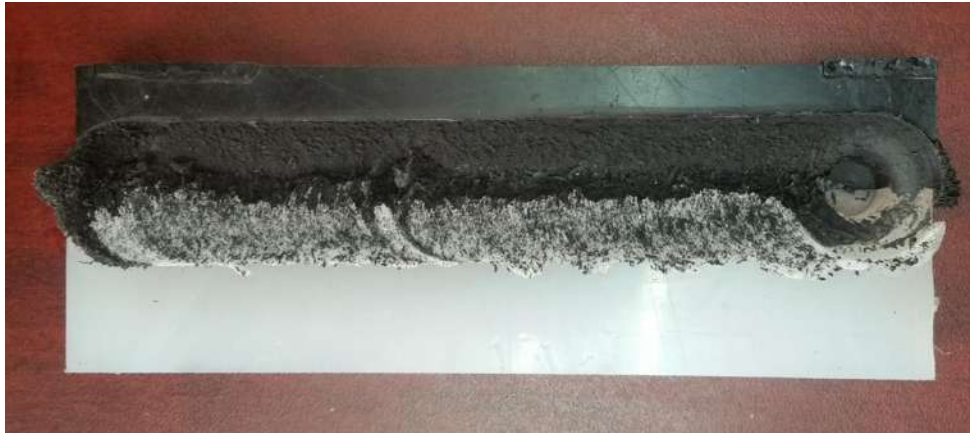
Figura 28. FSW de placas de ABS y polipropileno (sin defecto de túnel).
