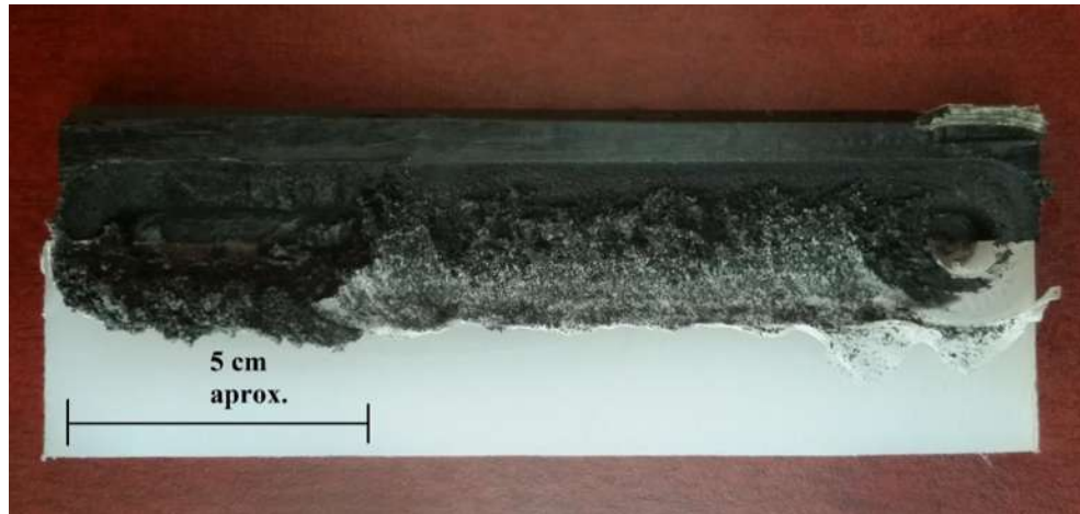
Figura 27. FSW de ABS y PP (defecto de túnel de 5 cm aproximadamente).
