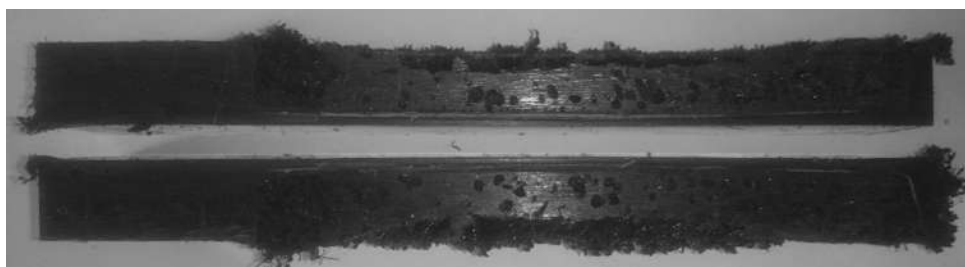
Figura 22. Corte longitudinal de la soldadura de placas de ABS (porosidad).
