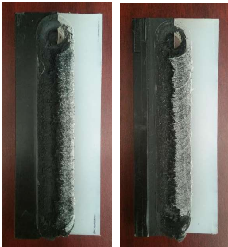
Figura 30. Polímeros soldados con velocidades de avance de 3 mm/min (izquierda) y 1.5 mm/min (derecha).
