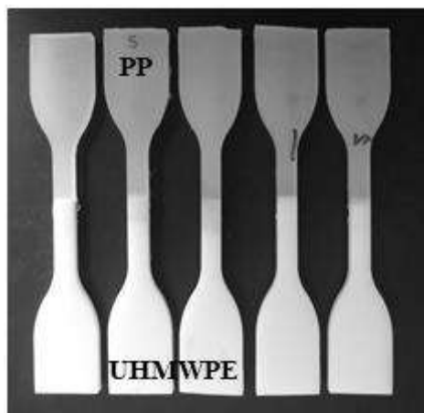
Figura 19. Probetas PP-UHMWPE para ensayos de tensión (norma ASTM D638-14).
