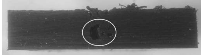
Figura 23. Corte transversal de la soldadura de placas de ABS (defecto túnel).
