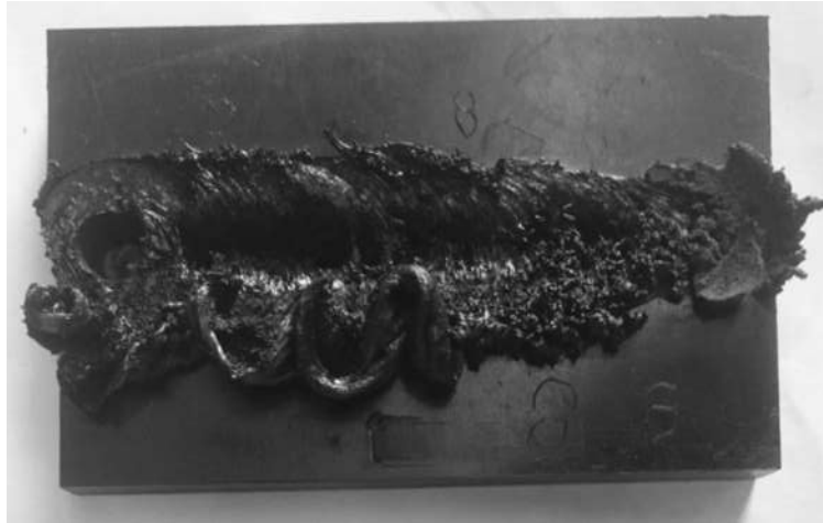
Figura 24. FSW de placas de ABS (rebabas).
