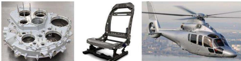
**Figura 2. 20** Aplicaciones de aleaciones base Mg en aeronaves.
