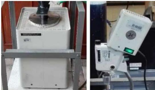
**Figura 3. 4** Horno vertical LindBerg Blue y agitador eléctrico Heldolph.
