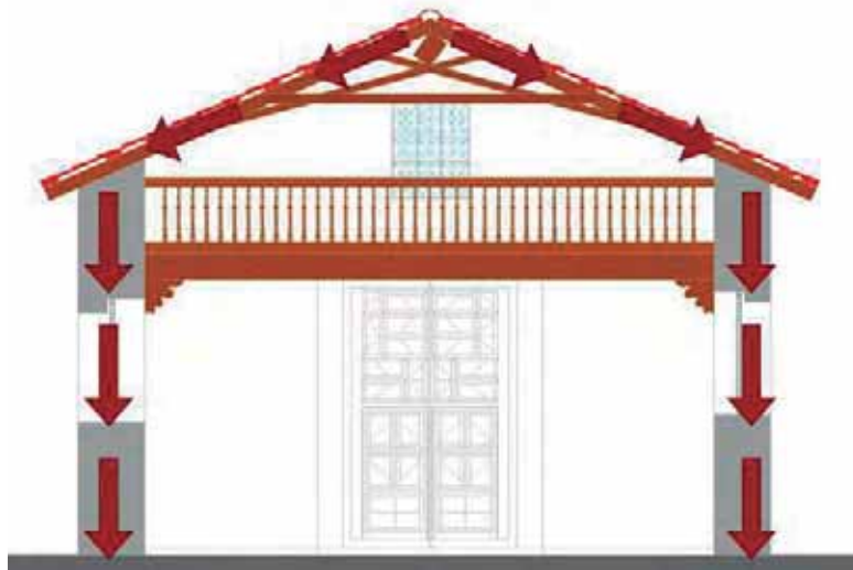
Figura 63. Transmisión de cargas. Elaboró: Saleta Lizbeth Vargas Viveros
