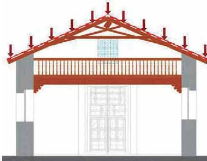
Figura 65. Cargas de la cubierta. Elaboró Saleta Lizbeth Vargas Viveros.
