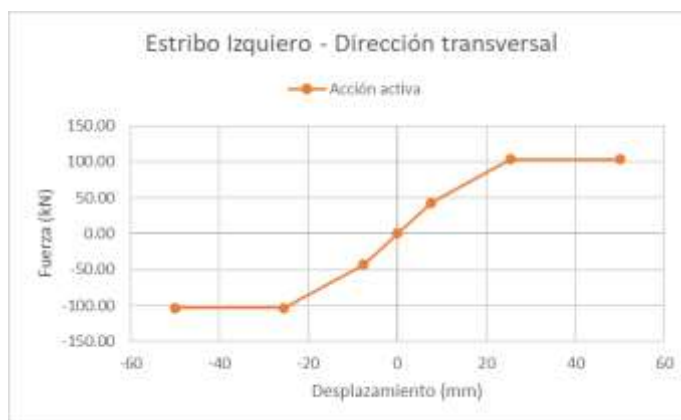
Figura 5- 49 Curva Backbone del estribo izquierdo, dirección transversal para los tres tipos de suelo.
