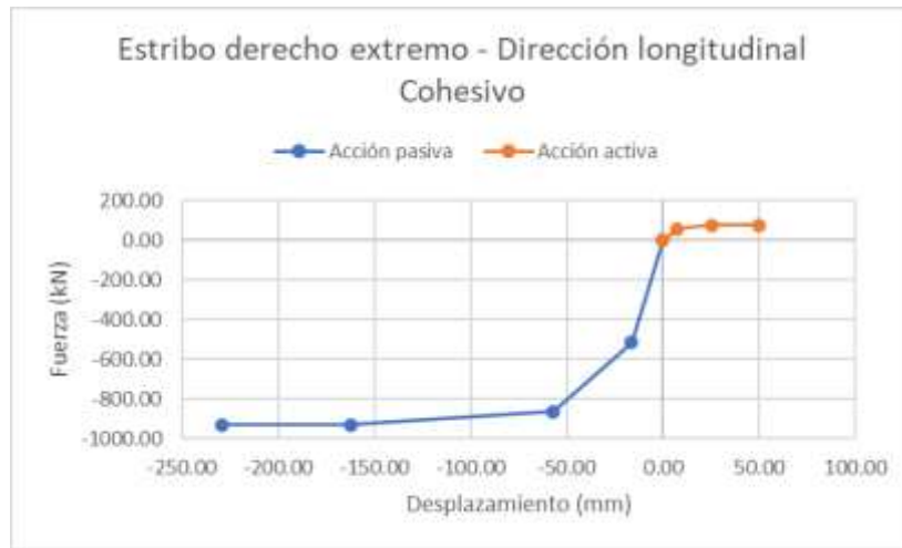
Figura 5- 44 Curva Backbone del estribo extremo derecho, dirección longitudinal con suelo cohesivo.
