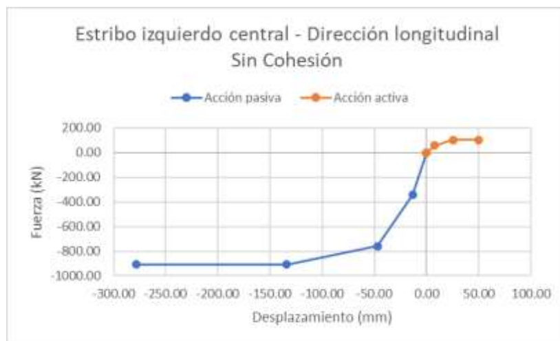
Figura 5- 37 Curva Backbone del estribo central izquierdo, dirección longitudinal con suelo sin cohesión.
