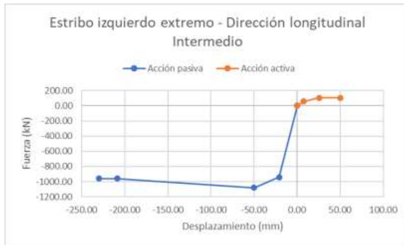
Figura 5- 42 Curva Backbone del estribo extremo izquierdo, dirección longitudinal con suelo intermedio.
