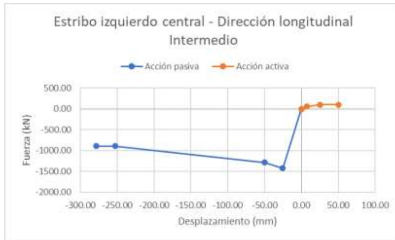
Figura 5- 41 Curva Backbone del estribo central izquierdo, dirección longitudinal con suelo intermedio.
