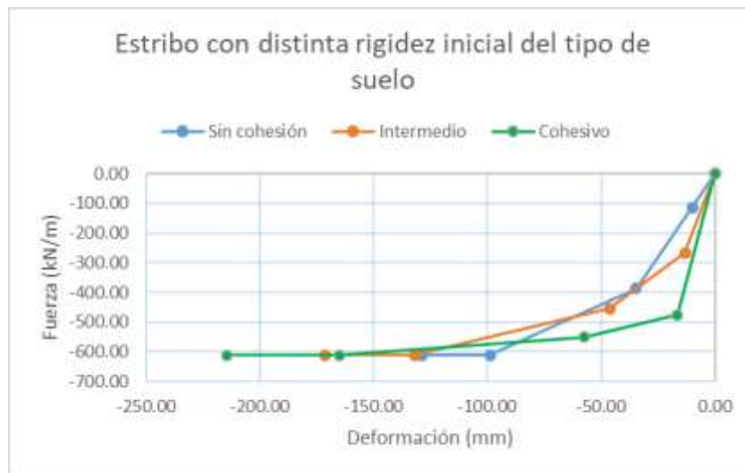
Figura 5- 33 Gráfica con distinta rigidez inicial del estribo.
