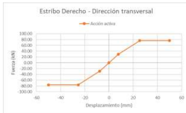
Figura 5- 48 Curva Backbone del estribo derecho, dirección transversal para los tres tipos de suelo.
