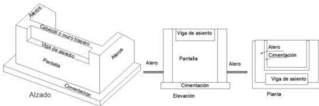
Figura 5- 17 Estribo en U, alzado, elevación y planta.
