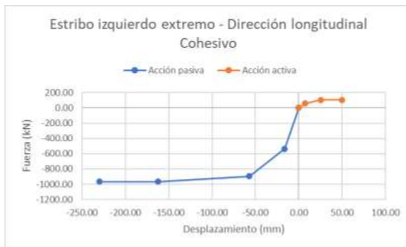
Figura 5- 46 Curva Backbone del estribo extremo izquierdo, dirección longitudinal con suelo cohesivo.
