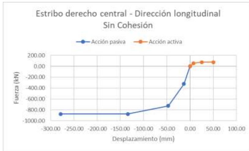
Figura 5- 35 Curva Backbone del estribo central derecho, dirección longitudinal con suelo sin cohesión.
