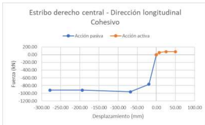
Figura 5- 43 Curva Backbone del estribo central derecho, dirección longitudinal con suelo cohesivo.
