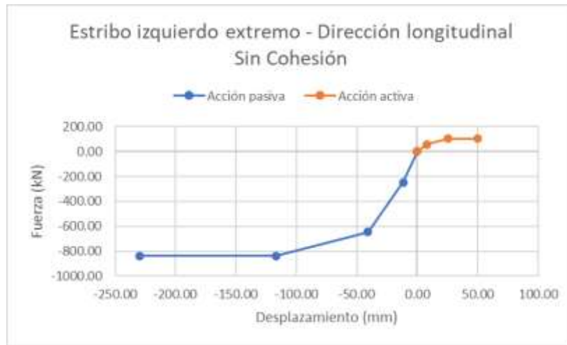
Figura 5- 38 Curva Backbone del estribo extremo izquierdo, dirección longitudinal con suelo sin cohesión.
