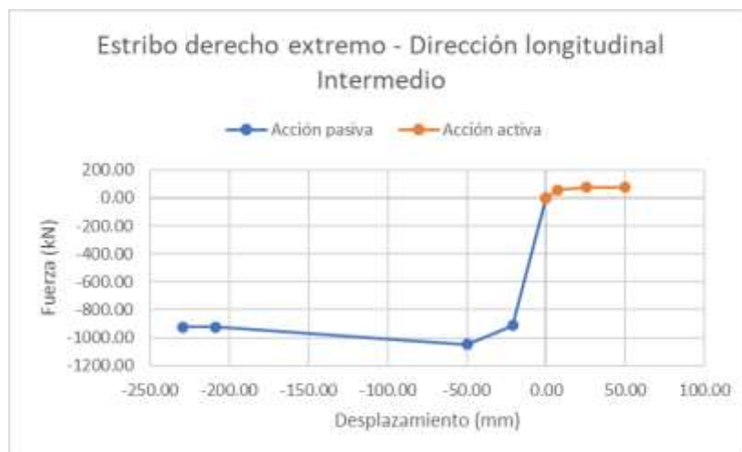
Figura 5- 40 Curva Backbone del estribo extremo derecho, dirección longitudinal con suelo intermedio.
