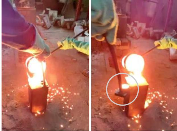
**Figura 3.8.** Toma de la muestra para análisis químico durante el vaciado.
