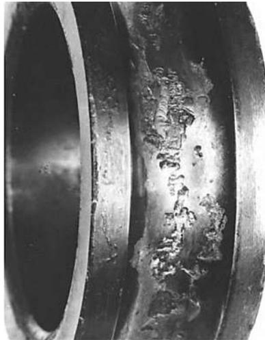
**Figura 2.12.** Desprendimiento de una pista de rodamiento de bolas 52100 (designación básica de cinco dígitos) debido a la fatiga de debajo de la superficie [50].
