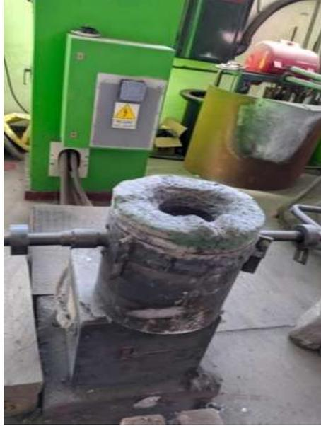
**Figura 3.2.** Horno de inducción con capacidad de 30 kg utilizado para la fusión de las aleaciones de hierro.
