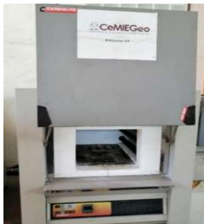
**Figura 3.11.** Horno eléctrico marca Carbolite.
