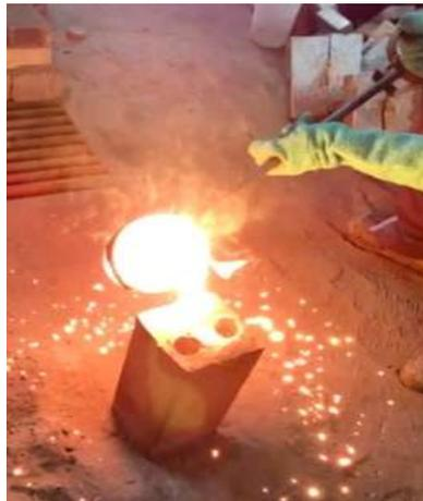
**Figura 3.7.** Vaciado del metal fundido en molde de arena.
