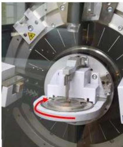
**Figura 3.15.** Difractómetro de rayos-X indicando la rotación de la muestra para el método de cuantificación de fases.
