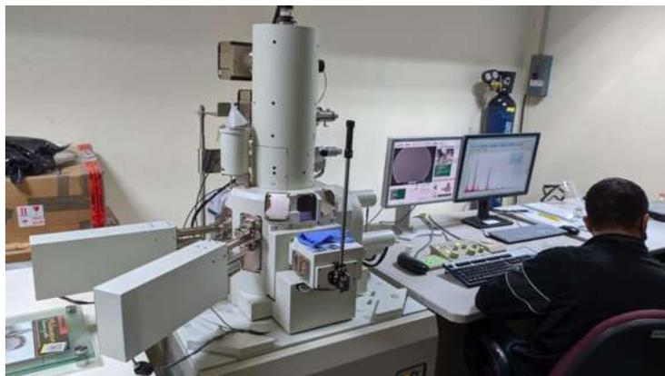
**Figura 3.14.** Microscopio electrónico de barrido marca Jeol modelo 7600.
