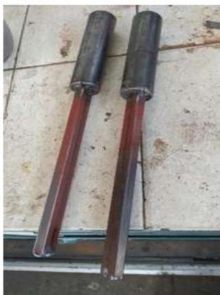
**Figura 3.3.** Modelo metálico para moldeo en arena.
