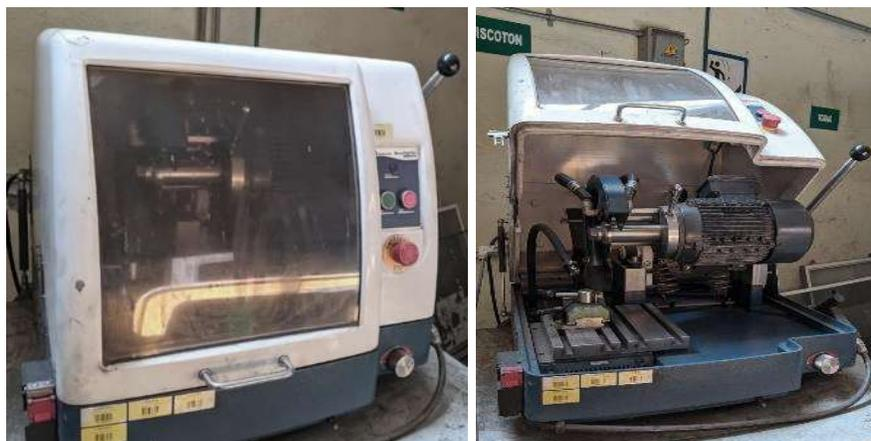
**Figura 3.9.** Cortadora metalográfica Buehler modelo AbrasiMet 250.
