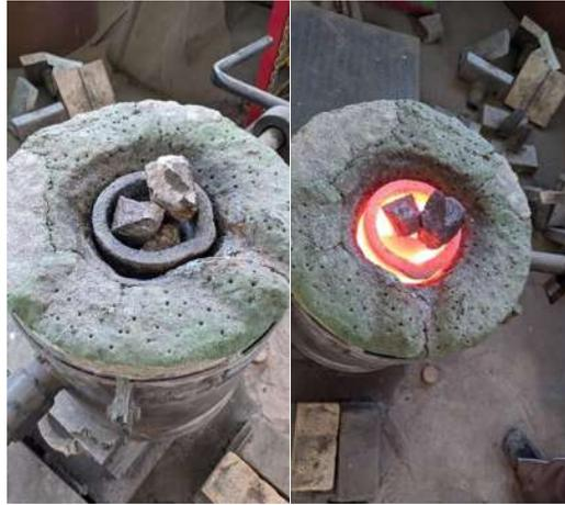
**Figura 3.5.** Crisol cargado con metal Sorel en proceso de fundición.
