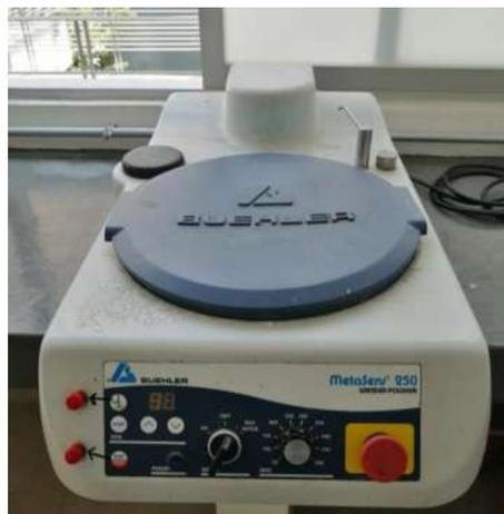
**Figura 3.12.** Pulidora marca Buehler modelo MetaServ 250 utilizada para el desbaste y pulido de las muestras con paño de nylon y pasta de diamante.
