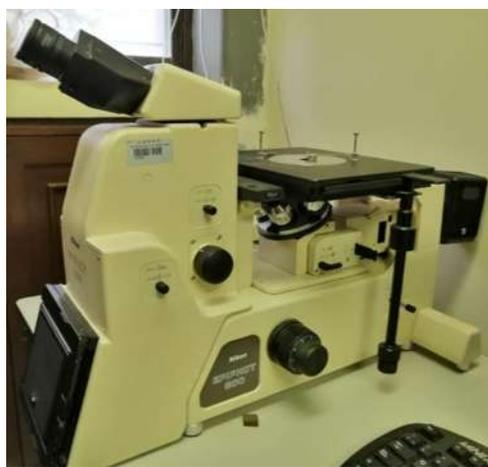
**Figura 3.13.** Microscopio marca Nikon modelo Epiphot 300.
