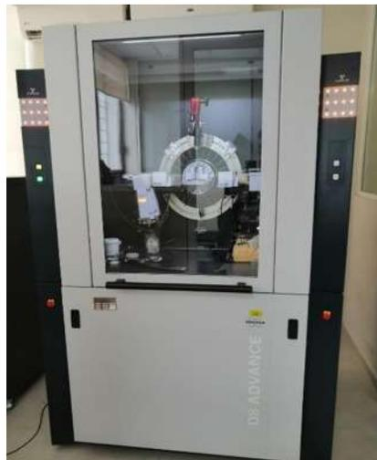
**Figura 3.16.** Difractómetro de rayos-X marca Bruker® modelo D8 Advance.
