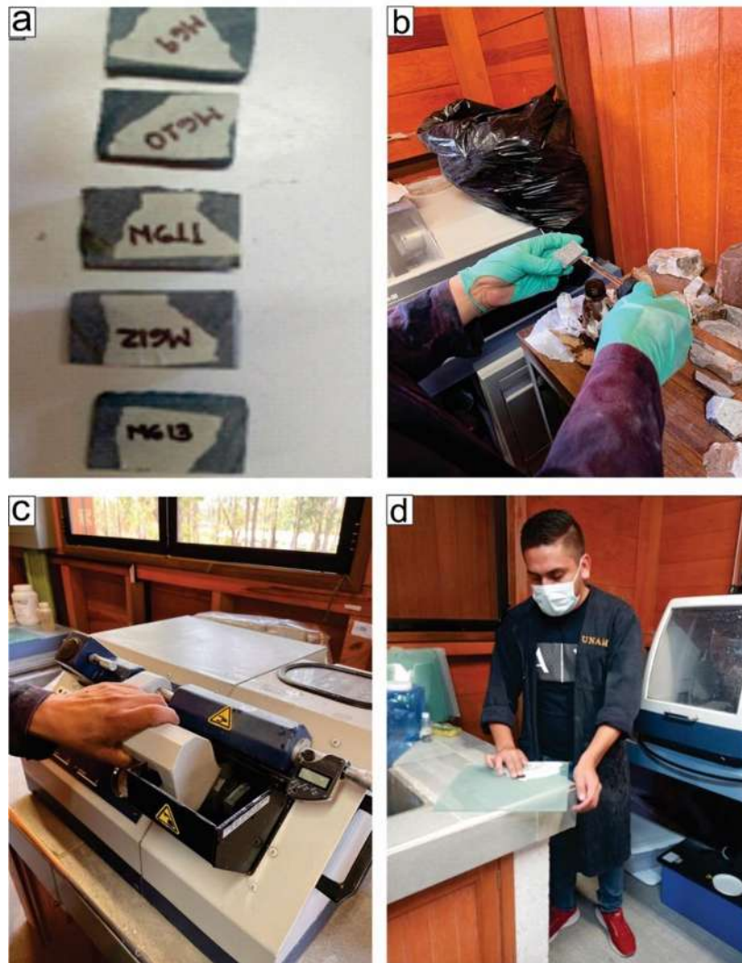
Figura 9. Procedimiento para la elaboración de láminas delgadas. a) Cortes de muestra de aproximadamente 4x2 cm; b) resina Epoxi UV para adherir la muestra de roca al portaobjetos de vidrio; c) corte de la lámina en la cortadora Petro Thin; d) proceso final de desgaste de la muestra con abrasivos de 600 y 1000 \mu\text{m} dejándola con un espesor de 30 \mu\text{m} .
