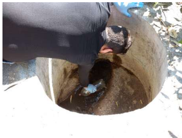
Figura 16. Extracción de la muestra
