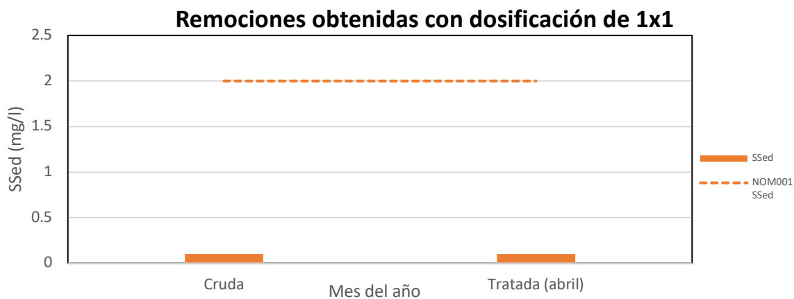
Figura 27. Remociones en Sólidos Sedimentables obtenidos con la dosificación 1x1
