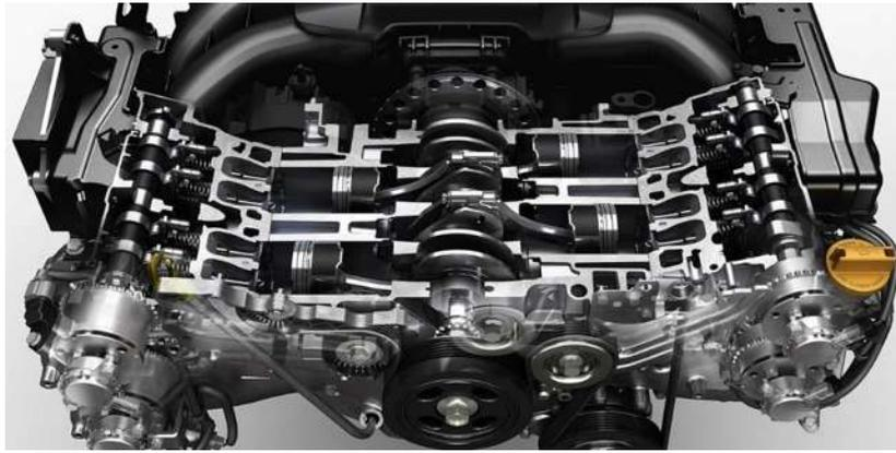
Figura 2.2. 2 Motor de 4 cilindros opuestos [42].
