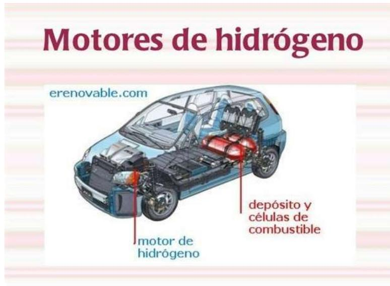
*Figura 2.6 Localización de motor y depósito de celdas de combustible en un motor a hidrogeno*
