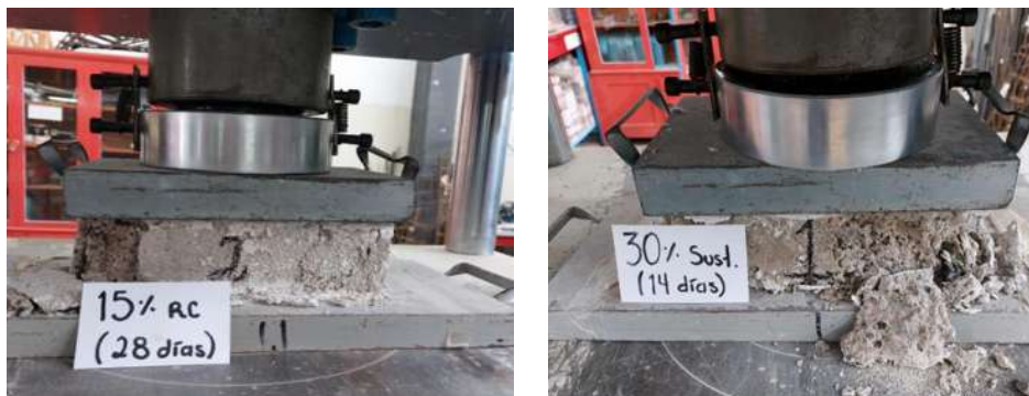
Figura 35. Mecanismo de falla de los tabicones elaborados con RCD.
