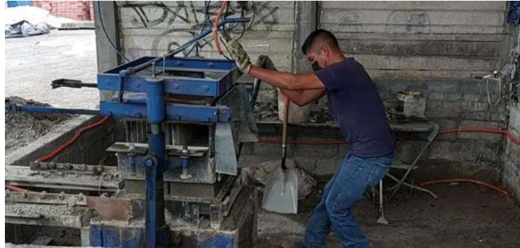
Figura 13. Retiro del molde en tabicones.
