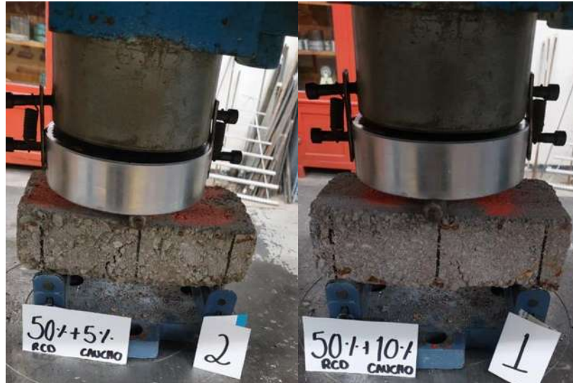
Figura 49. Ensaye de Flexión estática para determinación del MR de tabicónes elaborados con RCD + caucho.
