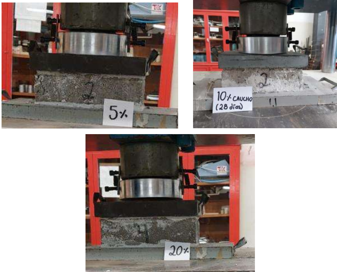
Figura 36. Mecanismo de falla de los tabicones elaborados con caucho.
