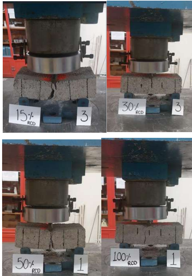
Figura 47. Ensayo de Flexión estática para determinación del MR de tabicones elaborados con RCD.
