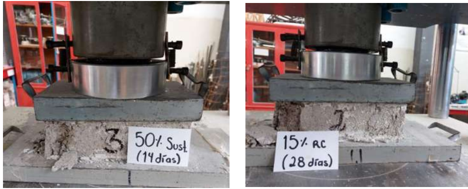
Figura 36. Mecanismo de falla de los tabicones elaborados con caucho.
