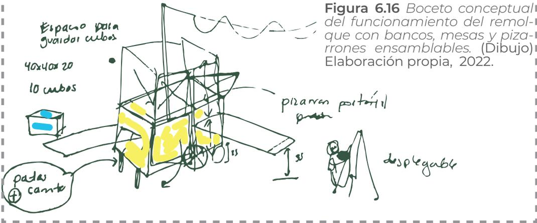
**Figura 6.16** Boceto conceptual del funcionamiento del remolque con bancos, mesas y pizarrones ensamblables. (Dibujo) Elaboración propia, 2022.
