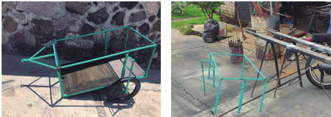
**Figura 6.22** Remolque de segunda mano adquirido para el aula móvil. El artefacto requería de refacciones (neumáticos) así como de una restauración general ya que presentaba óxido y partes desoldadas. (Fotografía propia) Morelia, Michoacán, 2022.
