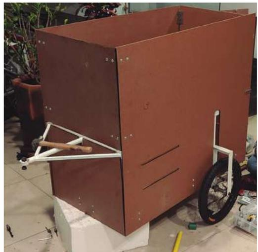
**Figura 6.25** *Proceso de fabricación del aula móvil con el remolque, las placas de MDF. (Fotografías propias, 2022).*
