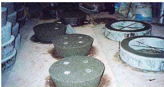
Alcantarillas y tapas de registros
