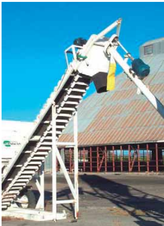
Foto 24. Bandas transportadoras para la elevación de los residuos de la tolva a la selección manual con motor de 5 Hp. 101
