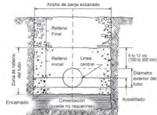
Ilustración 30 Sección transversal de la zanja
