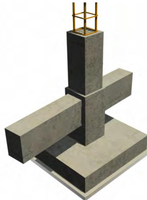
Ilustración 27 zapata de concreto reforzado
